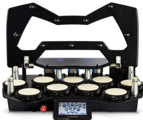
Ryc. 5. Urządzenie do badania ścieralności i mechacenia metodą Martindale'a [17]
