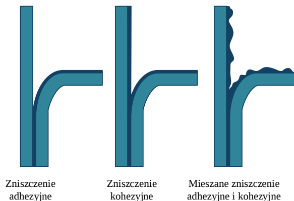
Rys. 3.9. Postacie zniszczenia połączenia klejowego [66]
