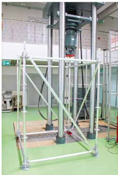
Fot. 16. Z lewej strony badanie wytrzymałości stojaków modułowego rusztowania aluminiowego z wykorzystaniem prasy ZWICK, a z prawej strony badanie ścieralności próbki betonowej wyciętej z kostki brukowej na tarczy Boehmego
