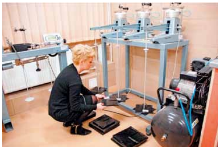
Fot. 15. Badanie ścisłości gruntów organicznych
