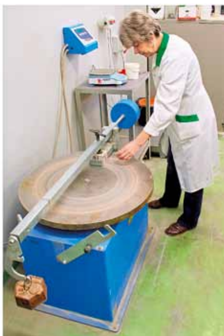
Fot. 16. Z lewej strony badanie wytrzymałości stojaków modułowego rusztowania aluminiowego z wykorzystaniem prasy ZWICK, a z prawej strony badanie ścieralności próbki betonowej wyciętej z kostki brukowej na tarczy Boehmego
