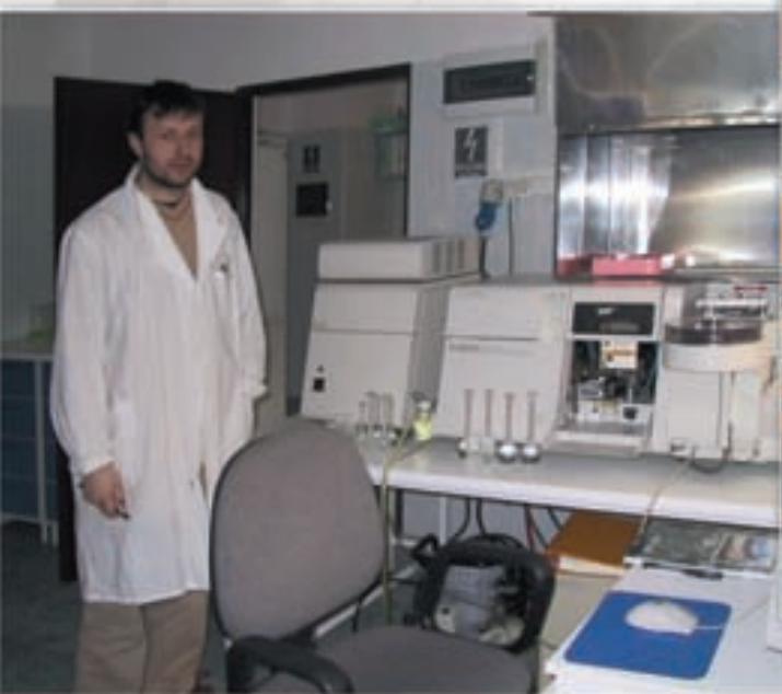
▼ Spektrometr absorpcji atomowej (Hitachi Z 8200) Atomic Absorption Spectrometer (Hitachi Z 8200)
