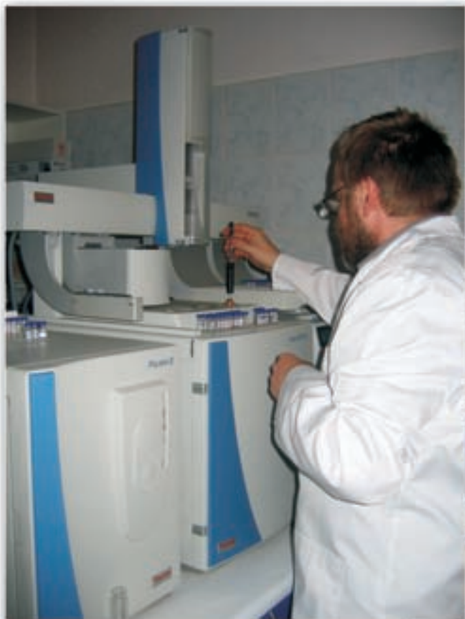
◀ Chromatograf gazowy sprzężony z tandemowym spektrometrem mas (GC-MS/MS) firmy Thermo GC-MS/MS system from Thermo Corporation
