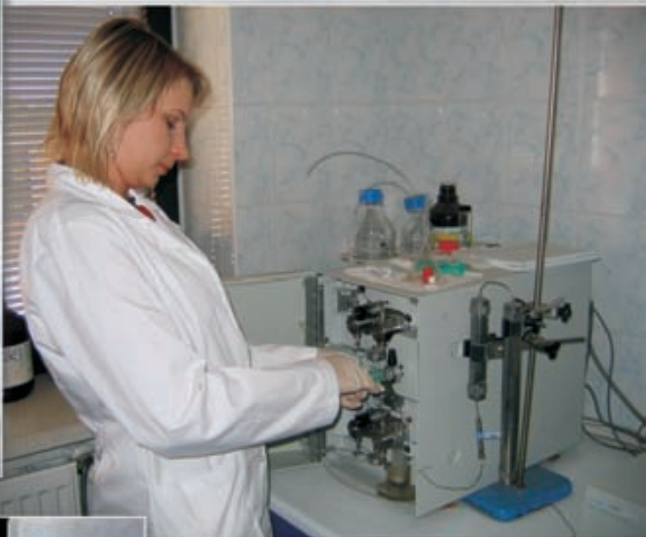
▶ Stacja oczyszczania ekstraktów z próbek oparta o system HPLC Breeze Clean-up station based on Breeze HPLC system
