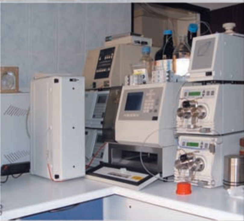
▲ Wysokosprawny chromatograf cieczowy (HPLC) serii 5000 firmy Waters wyposażony w detector UV-Vis i fluorescencyjny HPLC system 5000 series from Waters equipped with UV-Vis and fluorescence detection systems
