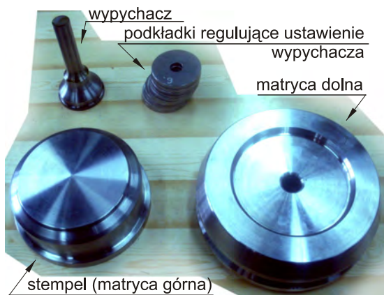
Rys. 3.25. Zestaw narzędzi wykorzystanych w badaniach doświadczalnych
