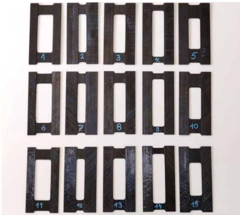
Rys. 3.6. Próbkki eksperymentalne płyt o układach niesymetrycznych w pięciu wariantach otworów oraz w trzech niesymetrycznych konfiguracjach warstw
