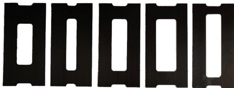
Rys. 3.3. Próbkki eksperymentalne płyt dla różnych parametrów geometrycznych wycięcia
