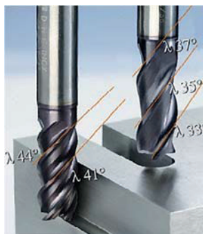
Rys. 1.27. Frezy o różnym kącie pochylenia linii śrubowej [52]
