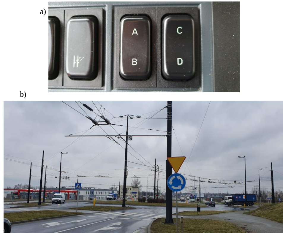
Rys. 4. a) Przyciski na pulpicie kierowcy A, B, C, D odpowiadające wysterowaniu kanałów zwrotnic odpowiednio 1, 2, 3, 4, b) Numer kanału zwrotnicy naklejony na tabliczce przyczepionej do sieci trakcyjnej.
