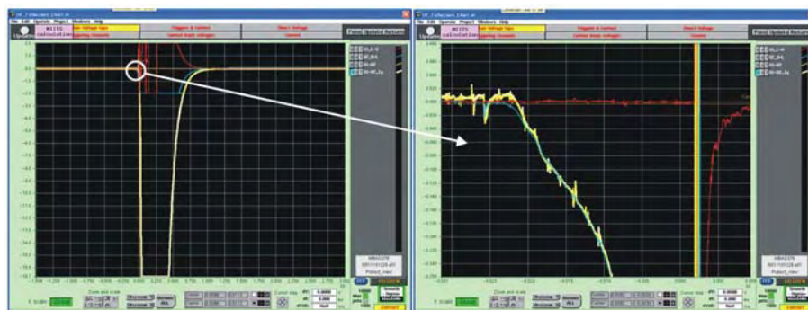
Rys. 6. Różnice napięć na głównych punktach pomiarowych elektromagnesu podczas quenchu
