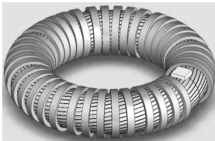
Rys.1. Transformator toroidalny HTS o przekładni 1:1
