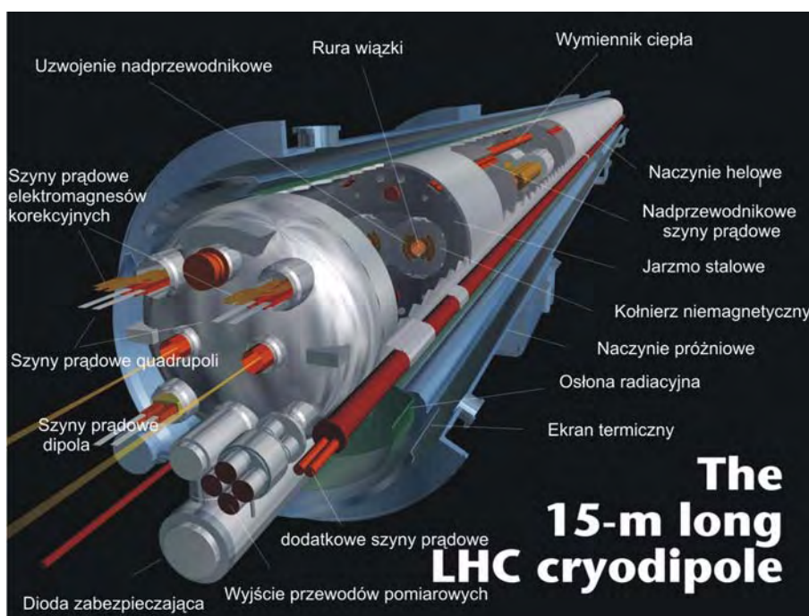
Rys.1. LHC dipol - elektromagnes nadprzewodnikowy o długości 15 m [2]
