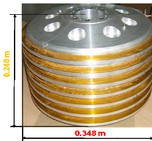
Rys.5 Elektromagnes z uzwojeniem nadprzewodnikowym dla SMES'a
