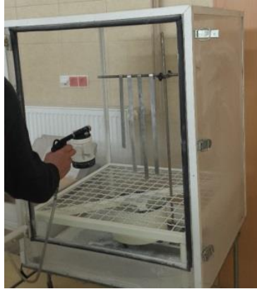
Rys. 42. Widok stanowiska do nanoszenia mieszanki smarowej na blachy
