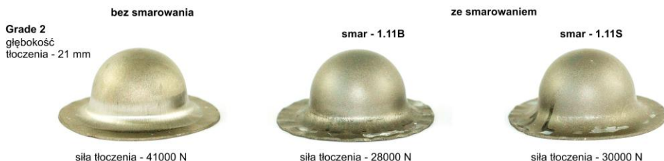
Rys. 71. Wpływ smarowania na siłę tłoczenia
