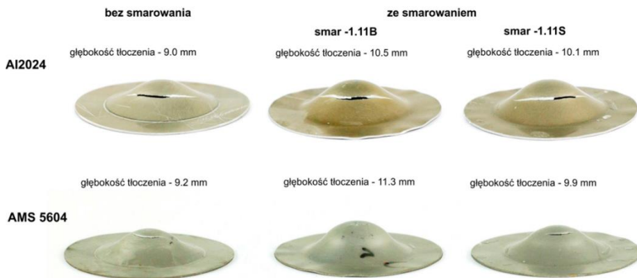
Rys. 70. Wpływ smarowania na głębokość wytłoczenia
