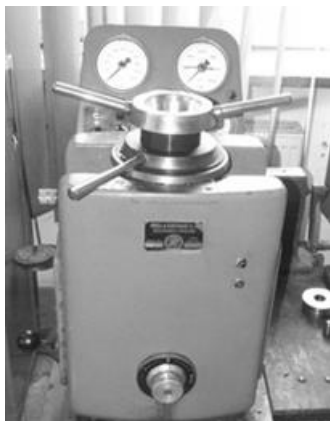
Rys. 22. Urządzenie do miseczkowania (a), tłocznik (b)
