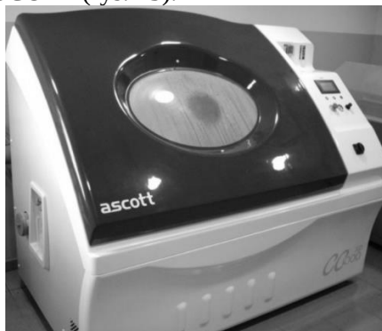
Rys. 23. Komora solna Ascott CC1000xp
