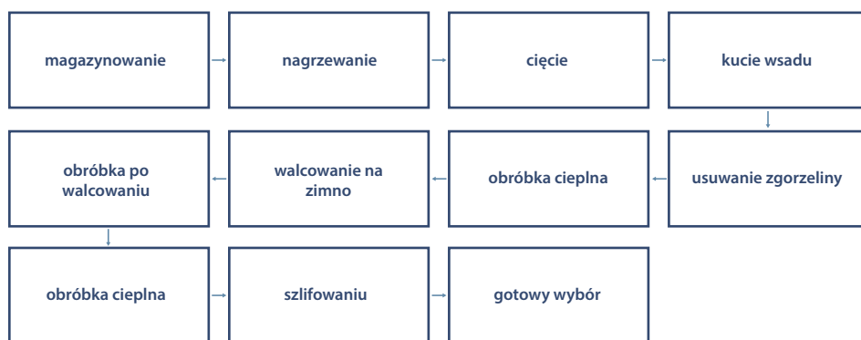
Ryc. 3.13. Etapy wykonania odkuwki pierścieniowej metodą walcowania pierścieni na zimno (opracowanie własne na podstawie [3])
