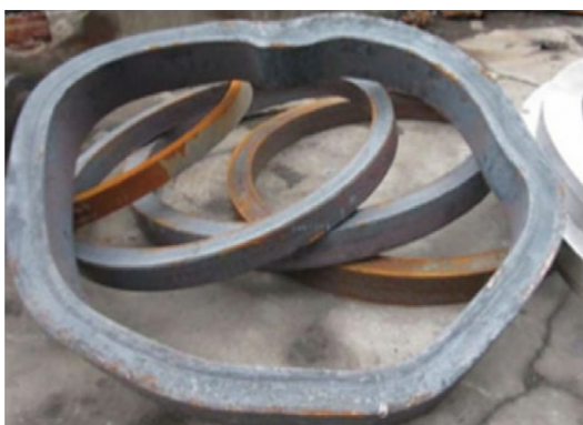
Ryc. 3.45. Wadliwe pierścienie uzyskane podczas walcowania promieniowo-osiowego [80]
