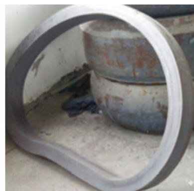
Ryc. 3.45. Wadliwe pierścienie uzyskane podczas walcowania promieniowo-osiowego [80]
