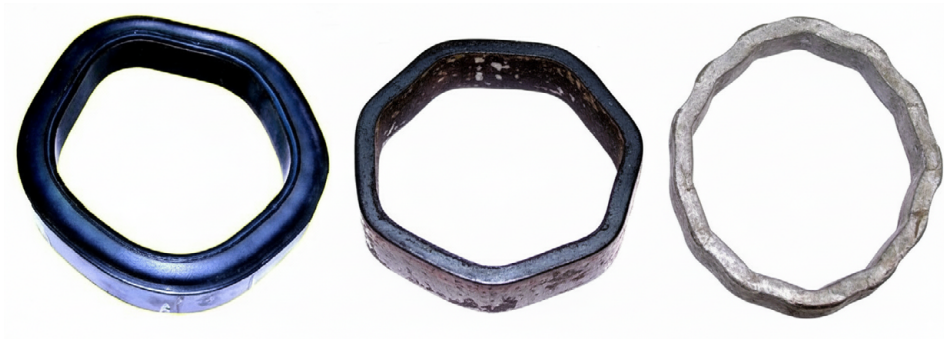
Ryc. 3.43. Wadliwe pierścienie – kształt wielokąta [51]
