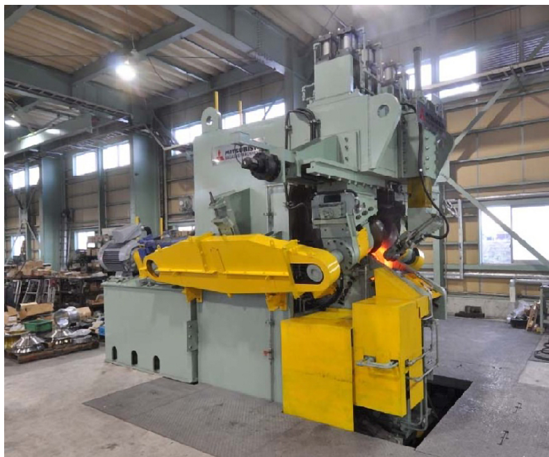
Ryc. 3.20. Zautomatyzowana pionowa walcarka do walcowania pierścieni o profilowym przekroju poprzecznym [125]
