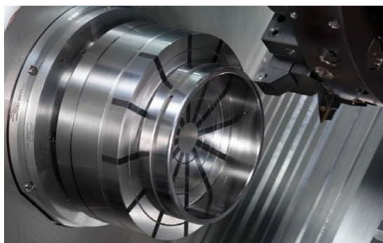
Ryc. 2.6. Pierścień uzyskany poprzez obróbkę skrawaniem [77]
