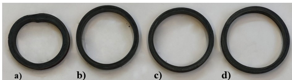
Ryc. 7.22. Wyniki uzyskane podczas procesu przeprowadzonego z prędkością dosuwu V = 5 mm/s: a) L_{rp} = 110 mm, b) L_{rp} = 115 mm, c) L_{rp} = 125 mm, d) L_{rp} = 135 mm
