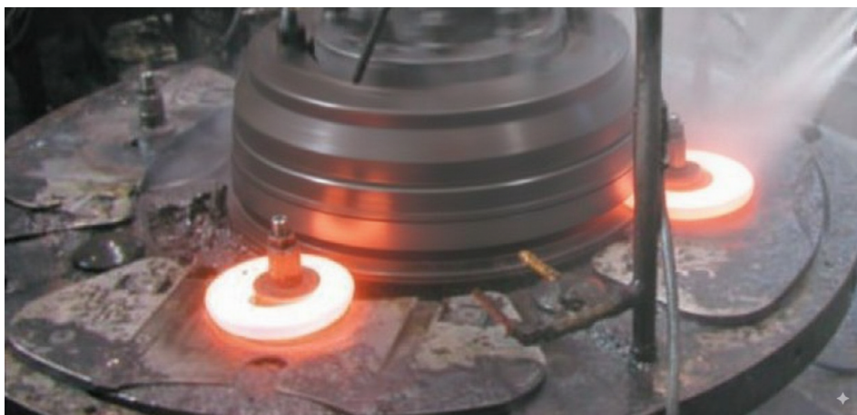
Ryc. 3.24. Walcarki stołowe z wieloma trzpieniami o kształtowej geometrii narzędzi [35]
