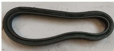
Ryc. 7.18. Pierścień zniekształcony na skutek złego ustawienia lewej rolki kalibrującej
