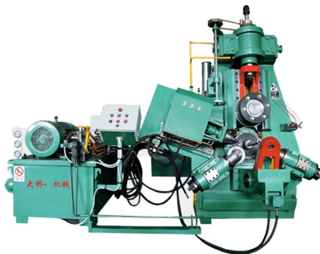
Ryc. 3.18. Walcarka pionowa do pierścieni firmy Wuxi Daqiao Bearing Machinery Co., Ltd. sterowana numerycznie [72]
