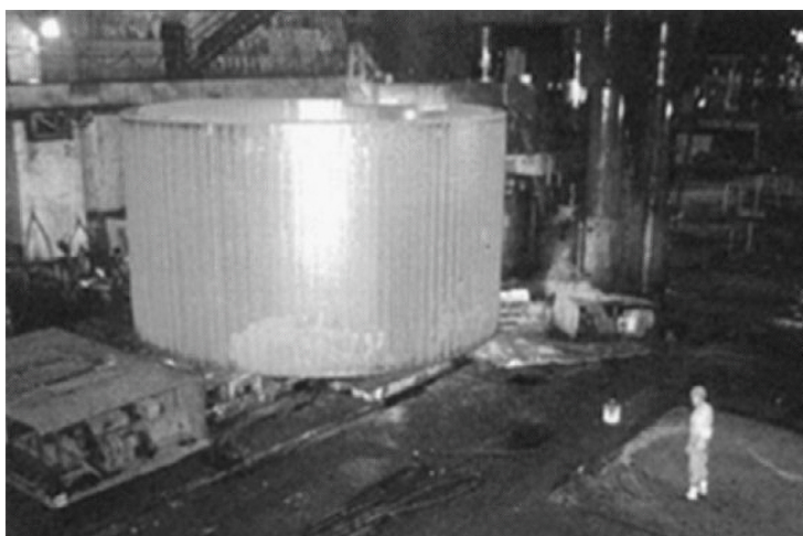
Ryc. 3.31. Odwalcowany pierścień (cylinder) na specjalnej walcarce pionowej [120]
