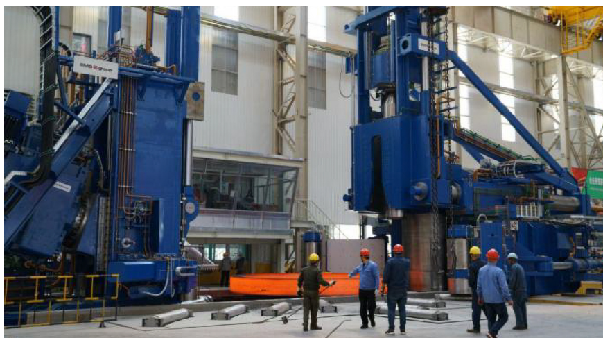
Ryc. 3.17. Największa na świecie walcarka promieniowo-osiowa firmy Elite [75]
