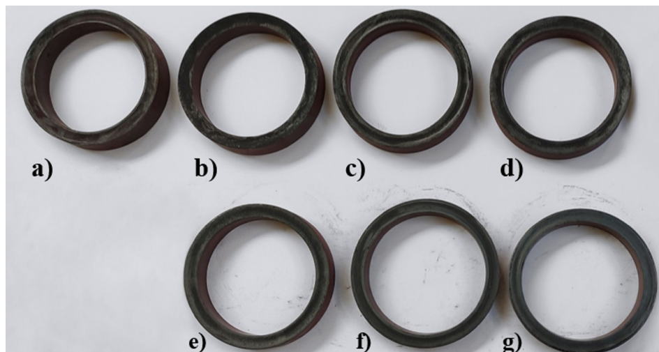
Ryc. 7.12. Pierścienie uzyskane podczas prób stanowiskowych dla poszczególnych wartości dosuwu V : a) 5 mm/s, b) 10 mm/s, c) 15 mm/s, d) 20 mm/s, e) 25 mm/s, f) 30 mm/s, g) 35 mm/s
