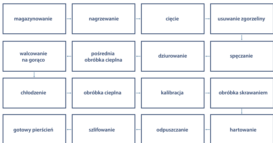
Ryc. 3.12. Etapy wykonania odkuwki pierścieniowej metodą walcowania pierścieni na gorąco (opracowanie własne na podstawie [3])
