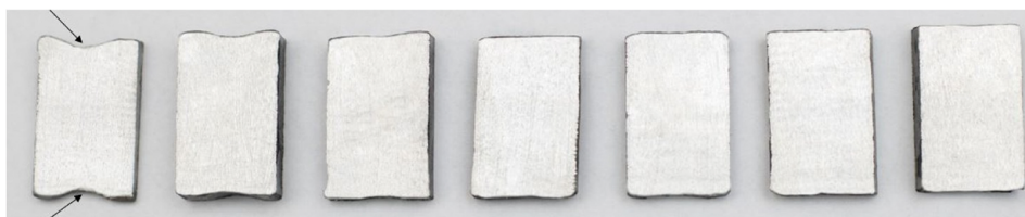
Ryc. 7.3. Kształt przekroju poprzecznego pierścienia uzyskanego w badaniach doświadczalnych przy prędkościach 5–35 mm/s (z krokiem 5 mm/s); strzałki wskazują wadę „rybiego ogona”
