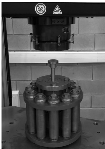
Rys. 6.41. Widok rzeczywisty przyrządu, wykorzystanego w badaniach doświadczalnych procesu wyciskania z ruchomą tuleją, zamontowanego na maszynie wytrzymałościowej
