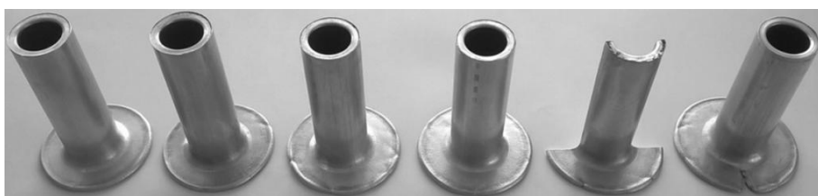
Rys. 6.14. Odkuwki z kołnierzami uzyskane podczas wyciskania promieniowego z zastosowaniem pojemnika o promieniu zaokrąglenia R_2=3\text{ mm} ; średnice kołnierzy kolejno od lewej wynoszą: 42, 43, 44, 45, 46, 47 mm
