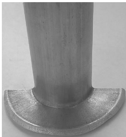
Rys. 6.15. Odkuwki z kołnierzem o średnicy: a) 43 mm i b) 44 mm, uzyskane podczas wyciskania promieniowego z zastosowaniem pojemnika o promieniu zaokrąglenia R_1=1 mm
