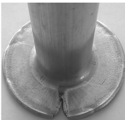
Rys. 6.16. Odkuwki z kołnierzem o średnicy: a) 46 mm, b) 47 mm, uzyskane podczas wyciskania promieniowego z zastosowaniem pojemnika o promieniu zaokrąglenia R_2=3 mm
