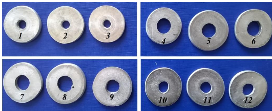
Rys. 5.9. Próbki spęcone z różnymi środkami smarnymi: 1÷3 – bez smarowania, 4÷6 – smar z dwusiarczkiem molibdenu, 7÷9 – lój z grafitem, 10÷12 – HeBoCoat 21E
