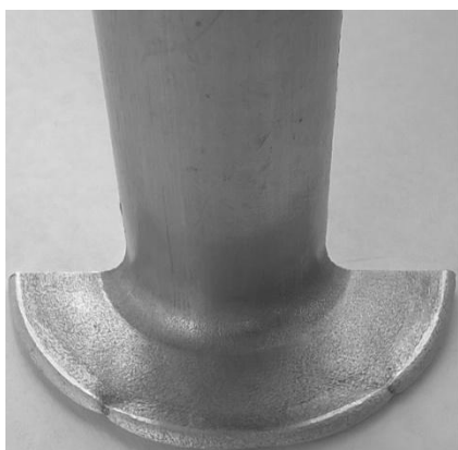
Rys. 6.16. Odkuwki z kołnierzem o średnicy: a) 46 mm, b) 47 mm, uzyskane podczas wyciskania promieniowego z zastosowaniem pojemnika o promieniu zaokrąglenia R_2=3 mm
