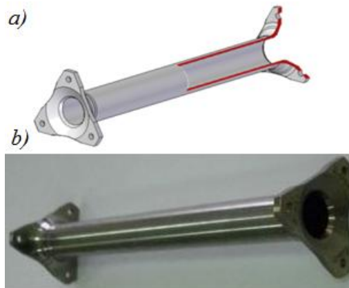
Rys. 2.14. Wał drążony z kołnierzami w kształcie rozety trójkątnej, a) model CAD, b) widok rzeczywisty [86]
