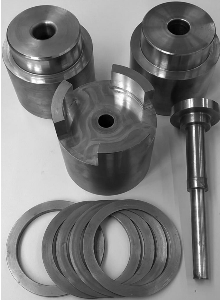
Rys. 6.5. Zestaw narzędzi wykorzystany do badań procesu wyciskania promieniowego (dwa pojemniki z promieniami zaokrąglenia R_1=1 mm oraz R_2=3 mm, podstawa, stempel, podkładki dystansowe)
