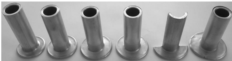
Rys. 6.13. Odkuwki z kołnierzami uzyskane podczas wyciskania promieniowego z zastosowaniem pojemnika o promieniu zaokrąglenia R_1=1\text{ mm} ; średnice kołnierzy kolejno od lewej wynoszą: 36, 38, 41, 42, 43, 44 mm
