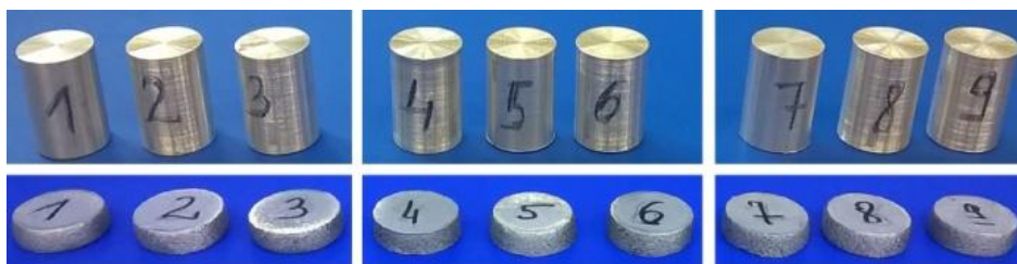
Rys. 5.5. Próbkki wykorzystane do wyznaczenia krzywej płynięcia stopu aluminium EN AW-6060
