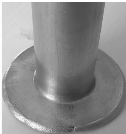
Rys. 6.15. Odkuwki z kołnierzem o średnicy: a) 43 mm i b) 44 mm, uzyskane podczas wyciskania promieniowego z zastosowaniem pojemnika o promieniu zaokrąglenia R_1=1 mm
