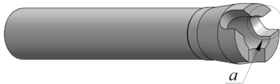
Rys. 2.11. Półfabrykat wykorzystywany podczas kształtowania kołnierza w kształcie rozety trójkątnej
