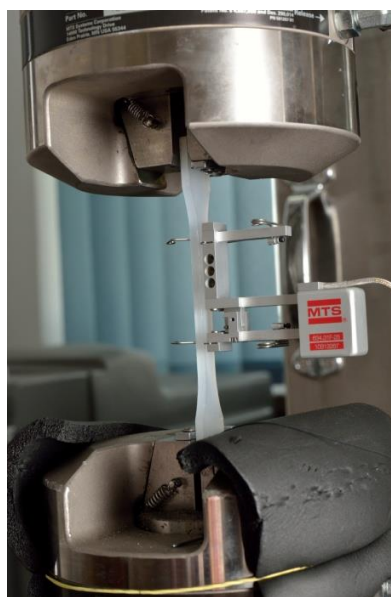
Rys. 43. Ekstensometr MTS 634.31F-25
