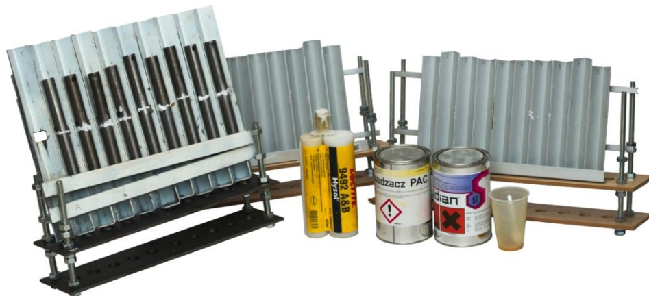
Rys. 33. Widok próbek na przyrządzie klejarskim
