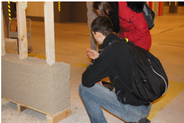
Cegła z konopi i wapnia jest lekka i bardzo wytrzymała. Wytrzymałość takiej cegły jest siedmiokrotnie wyższa niż betonu. Dodatkowym plusem jest ekologiczność, gdyż cegła ulega rozkładowi, tworząc nawóz (fot. K. Głęb)
