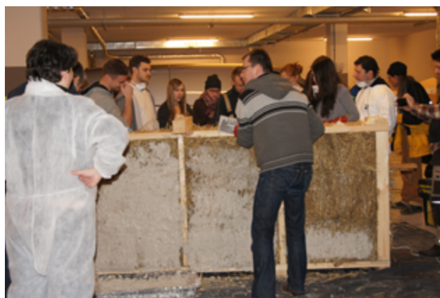
Stawbale powstają ze sprasowanych zbóż i służą jako wypełnienie konstrukcji drewnianego budynku. Słoma jest doskonałym materiałem izolacyjnym, jednak wadą jest podatność na gnienie (fot. K. Głąb)
