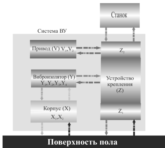
Рис. 3. Структурная схема системы виброизолирующего устройства (ВУ)
