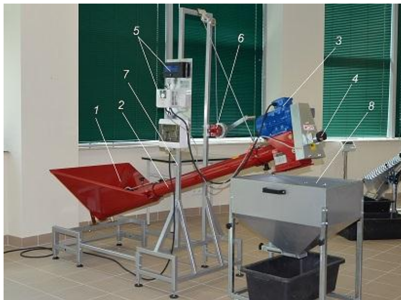
Rys. 2. Stanowisko badawcze PS-6/2014 przenośnika ślimakowego, 1 – zasobnik zbóż; 2 – rura transportowa przenośnika; 3 – zespół napędowy; 4 – czujnik prędkości obrotowej wału; 5 – panel kontrolno-sterujący; 6 – zespół podnoszący do regulacji kąta pochylenia; 7 – rama konstrukcyjna przenośnika; 8 – zbiornik na przetransportowany materiał [15]
