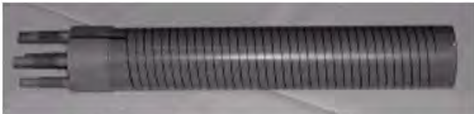
Rys.4. 24. Badany model ogranicznika o konstrukcji bifilarnej Powierzchnia przekroju nadprzewodnika wynosi 0,24 \text{ cm}^2
