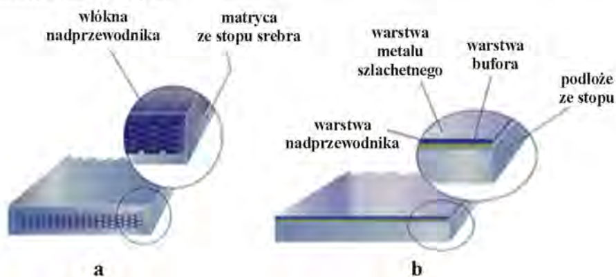
Rys. 2.17. Architektura przewodów wysokotemperaturowych [12]
