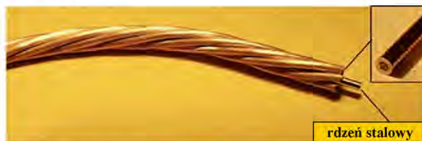
Rys. 2.18. Przewód zbudowany z nadprzewodnika \text{MgB}_2 z rdzeniem stalowym [6].
