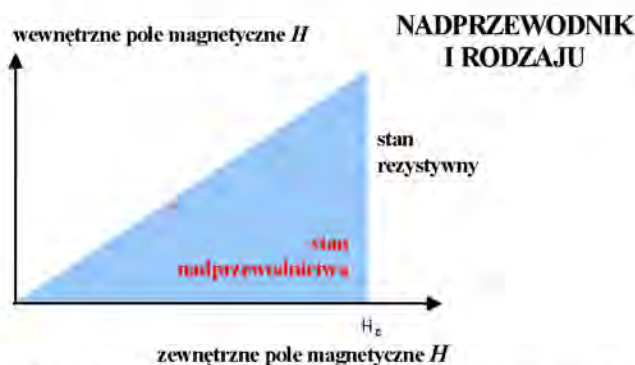
Rys. 2.10. Zmiany namagnesowania nadprzewodnika I rodzaju w funkcji zewnętrznego pola magnetycznego
