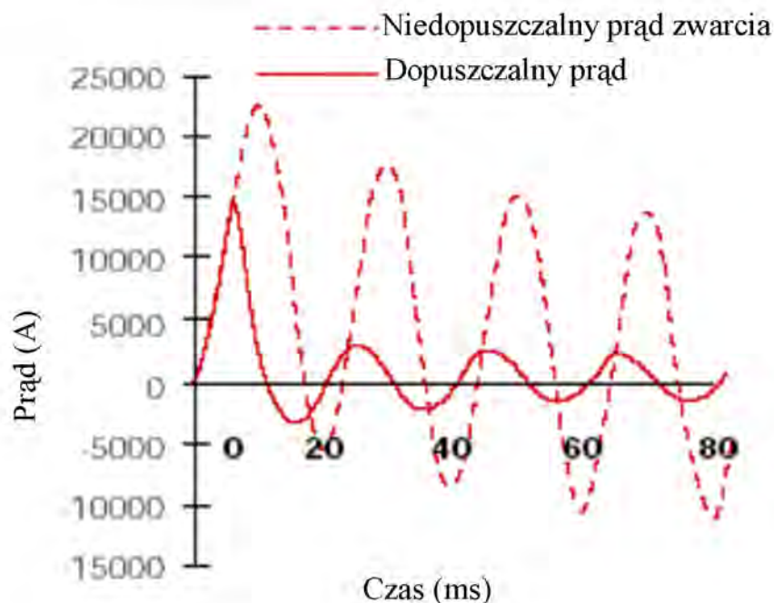
Rys. 4. 12. b Wykres zależności i(t) w czasie działania nadprzewodnikowego ogranicznika prądu ze sterowaniem za pomocą pola magnetycznego [10]
