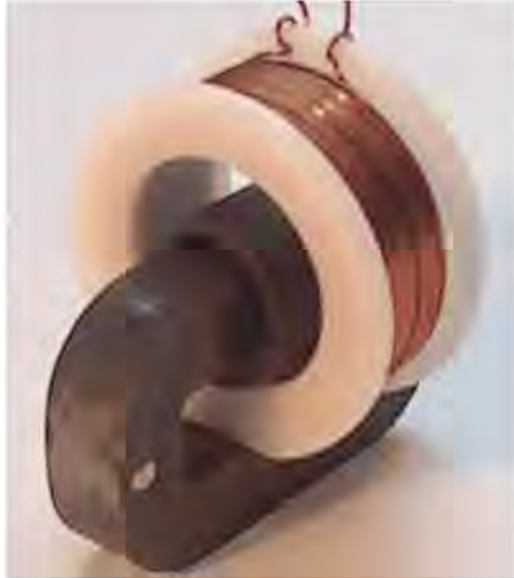
Rys. 5.12. Nadprzewodnikowy ogranicznik prądu z zamkniętym rdzeniem magnetycznym zwijanym, uzwojeniem pierwotnym o liczbie zwojów 448 i cylindrem nadprzewodnikowym o I_c = 112 A (77 K)
