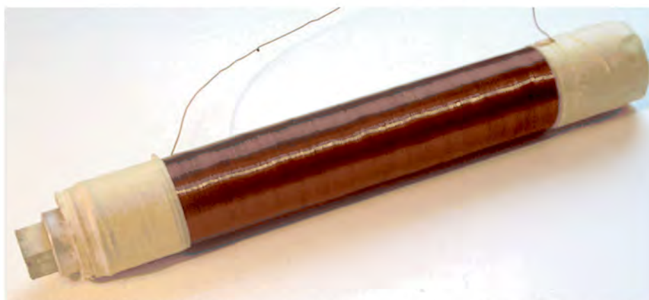
Rys. 5.26. Nadprzewodnikowy ogranicznik prądu z otwartym rdzeniem magnetycznym i cylindrem nadprzewodnikowym o I_c = 1210 A (77 K)
