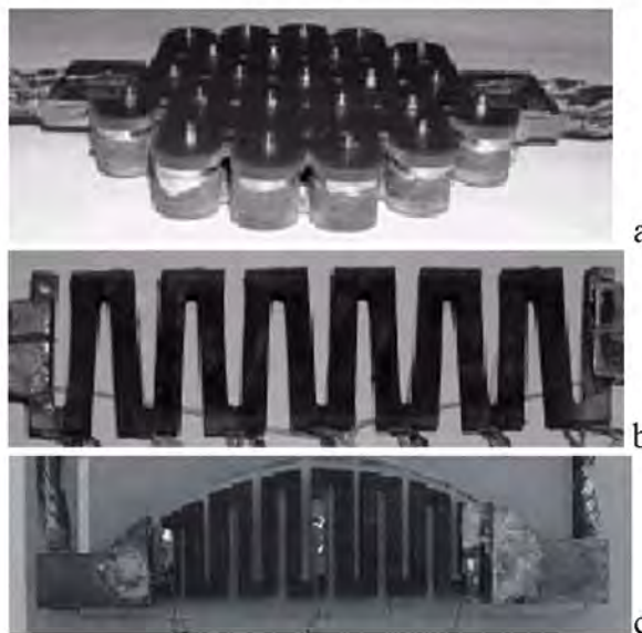
Rys. 4. 19. Modele nadprzewodnikowych meandrowych ograniczników prądu [6]
