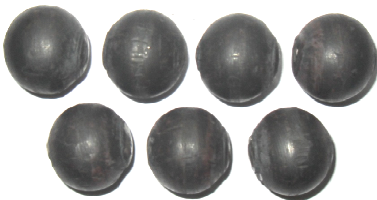
Rys. 4.28. Kule odwalcowane w trakcie badań laboratoryjnych trójzwojnym wykroju śrubowym, opracowanym w Politechnice Lubelskiej
