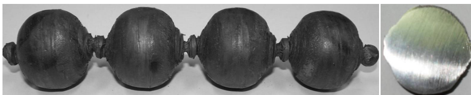
Rys. 2.26. Półwyroby kul S\varnothing 33 mm odwalcowane w walcach śrubowych połączone mostkami
