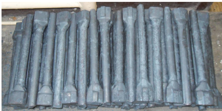
Rys. 6.23. Pręty o średnicy \varnothing 42 odwalcowane w czterech przepustach w walcierce kuźniczej z główek złomowanych szyn kolejowych
