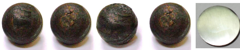
Rys. 3.28. Kule odwalcowane w trakcie badań laboratoryjnych w wykroju skalibrowanym wg metody opracowanej w Politechnice Lubelskiej
