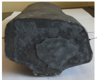
Rys. 6.22. Nierównomierne zużycie główki szyny kolejowej S60 (zaznaczone strzałką), będące przyczyną nieprawidłowego wypełnienia wykroju owalnego w pierwszym przepuście
