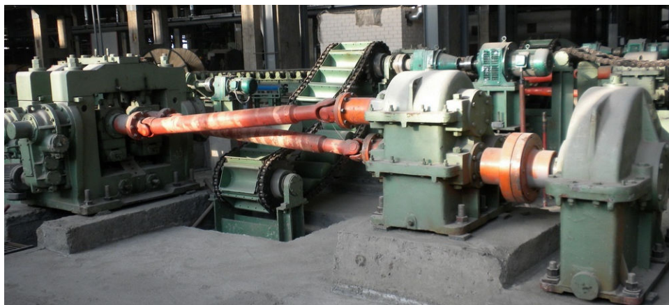
Rys. 2.15. Linia walcownicza do walcowania skośnego kul o wymiarach \varnothing 60 mm firmy Anyang Forging Press Machinery Industry (Chiny) [11]
