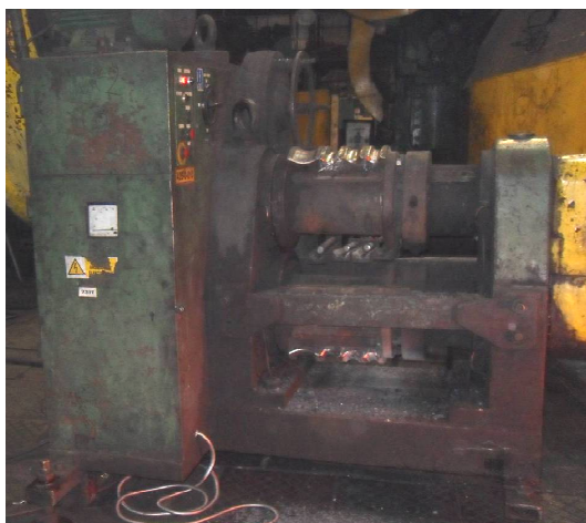
Rys. 6.20. Fotografia walcarki kuźniczej WK 2 znajdującej się w jednym z krajowych zakładów kuźniczych, którą zastosowano do realizacji procesu walcowania prętów z główek złomowanych szyn kolejowych
