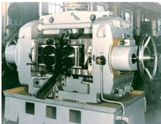
Rys. 2.14. Klatka robocza walcarki skośnej ШПС 20-60 firmy VNIIMETMASH [12]
