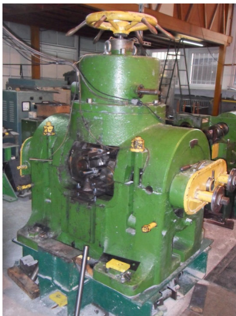
Rys. 2.21. Walcarka skośna zabudowana w układzie dwóch walców roboczych, zainstalowana w laboratorium Katedry Plastycznej Przeróbki Metali AGH w Krakowie, w której wykonano próby walcowania kul S\varnothing 33 mm (widok od strony prowadzenia wsadu)
