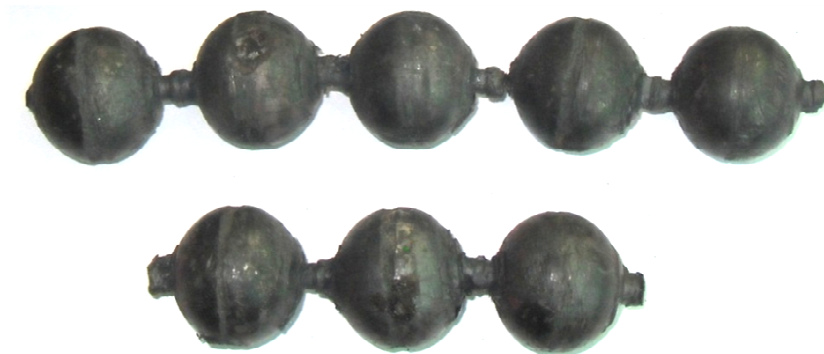
Rys. 4.29. Kule ukształtowane w procesie walcowania w wielozwojnych wykrojach śrubowych połączone ze sobą za pomocą szyjek z widocznym niewielkim wypełnieniem zarysu
