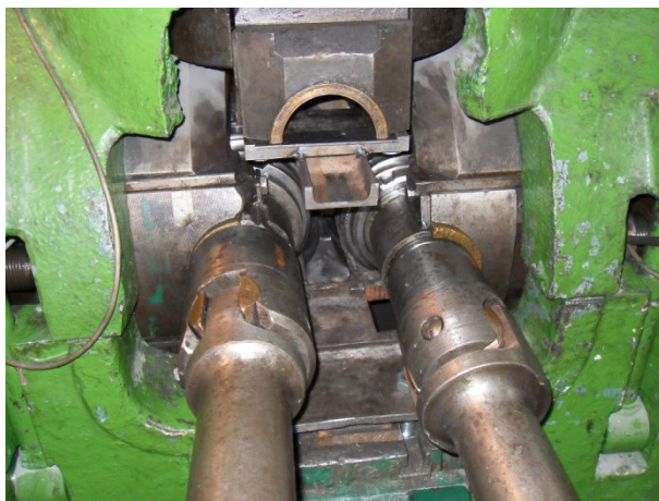
Rys. 2.24. Komplet narzędzi (walców i listew prowadzących) zabudowanych w walcarce i wykorzystanych w procesie walcowania śrubowego kul (widok od strony odbioru półwyrobów)
