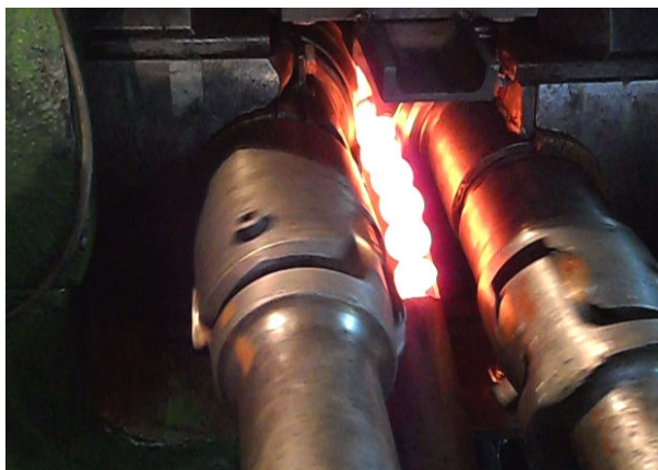
Rys. 2.25. Półwyroby kul S\varnothing 33 mm otrzymane w procesie walcowania śrubowego, odbierane przez prowadnicę rurową
