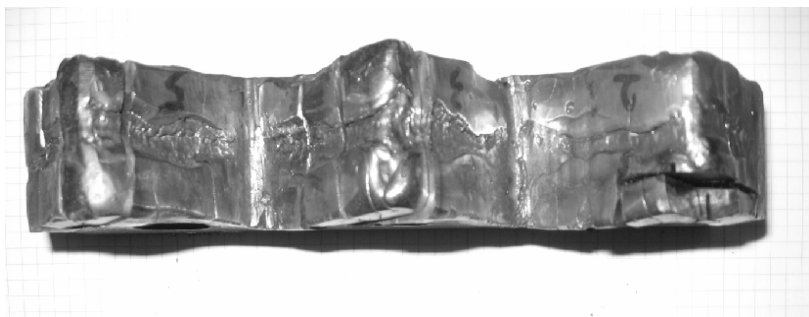
Rys. 5. Złomowany nóż stały granulatora napawany elektrodą OK 83.65
