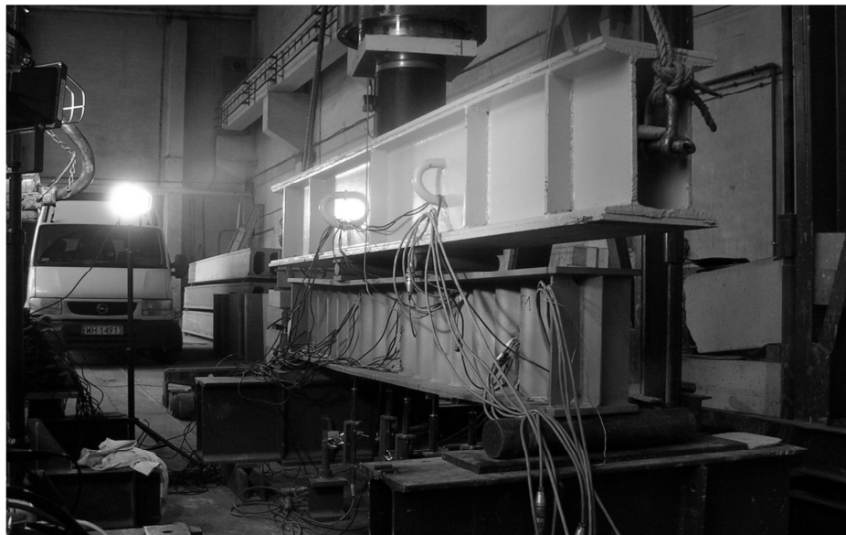
Rys. 3.34. Postać ugięcia belki F1 dla cyku NC-4, P=1200 kN
