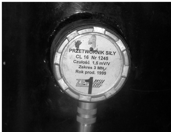
Rys. 3.1. Przetwornik siły CL16 firmy ZEPWN
