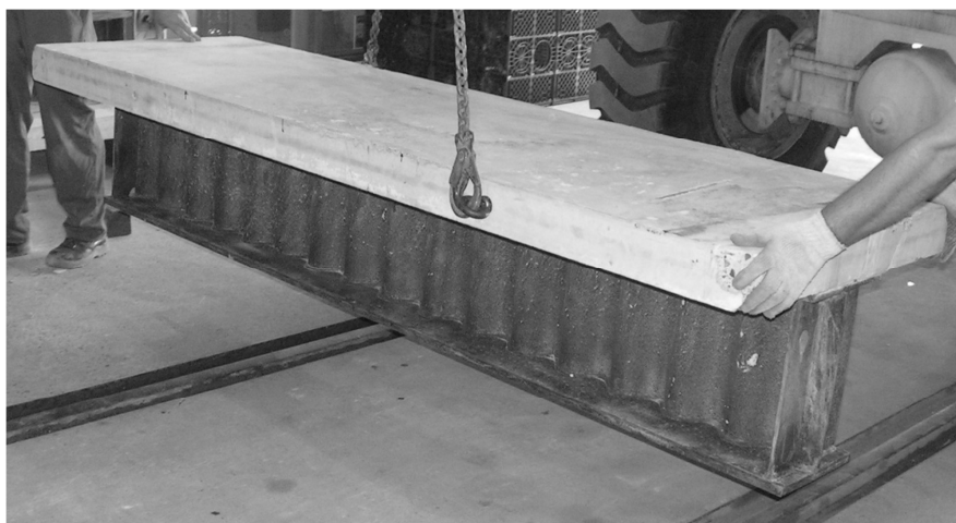
Rys. 3.15. Belka stalowa zespolona z płytą żelbetową
