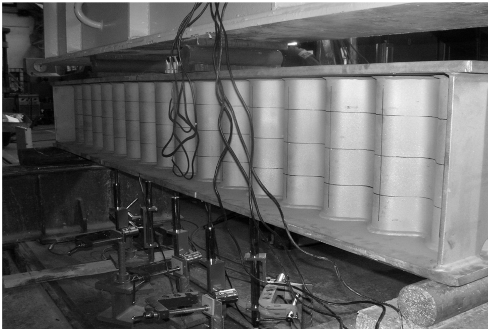
Rys. 3.11. Belki ze środkiem z blachy falistej na stanowisku badawczym
