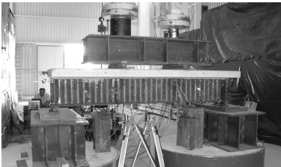
Rys. 3.7. Realizacja obciążenia zewnętrznego dla dźwigara 2ZB
