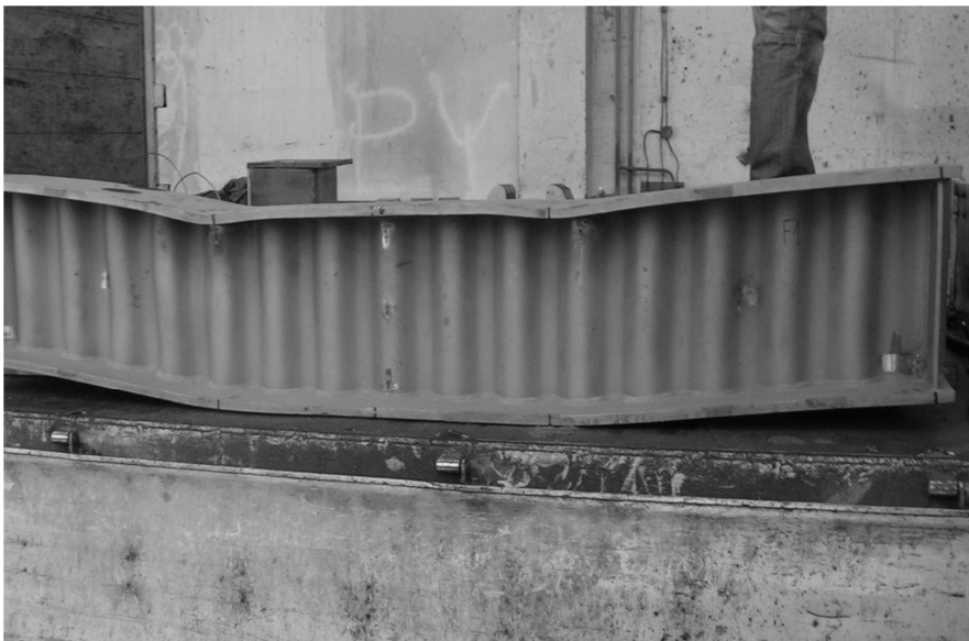
Rys. 3.54. Obraz zniszczenia belki F1
