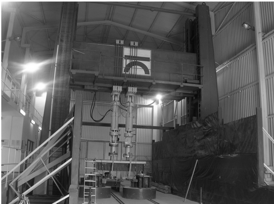
Rys. 3.5. Stanowisko STEND wyposażone w dwa siłowniki firmy Schenck
