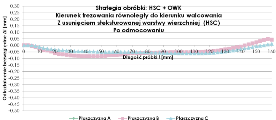
Rys. 8. Przebieg odkształcenia bezwzględnego \Delta l w funkcji długości próbki l , po odmocowaniu, dla strategii łączącej HSC z obróbką wykończeniową konwencjonalną (OWK), równoległego kierunku frezowania w stosunku do kierunku walcowania i wariantu z zastosowaniem obróbki wstępnej HSC
