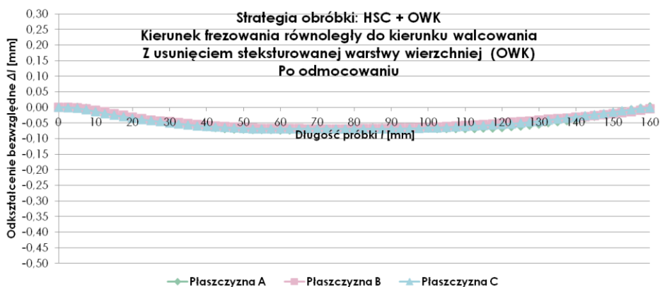
Rys. 8. Przebieg odkształcenia bezwzględnego \Delta l w funkcji długości próbki l , po odmocowaniu, dla strategii łączącej HSC z obróbką wykończeniową konwencjonalną (OWK), równoległego kierunku frezowania w stosunku do kierunku walcowania i wariantu z zastosowaniem obróbki wstępnej OWK
