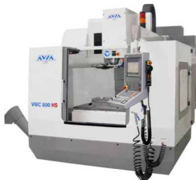
Rys. 4.5. Pionowe centrum obróbkowe Avia VMC 800 HS [15]
