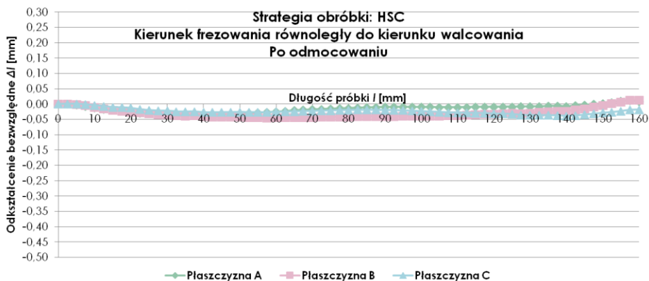
Rys. 7. Przebieg odkształcenia bezwzględnego \Delta l w funkcji długości próbki l , po odmocowaniu, dla strategii HSC, przy której kierunek frezowania do kierunku walcowania był równoległy i wariantu z niezaosowaniem obróbki wstępnej
