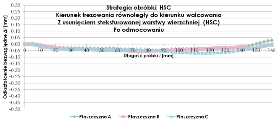
Rys. 7. Przebieg odkształcenia bezwzględnego \Delta l w funkcji długości próbki l , po odmocowaniu, dla strategii HSC, równoległego kierunku frezowania w stosunku do kierunku walcowania i wariantu z zastosowaniem obróbki wstępnej HSC
