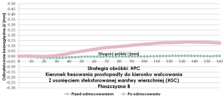
Rys. 5.35. Porównanie przebiegów odkształceń bezwzględnych \Delta l w funkcji długości próbki l w płaszczyźnie B, przed i po odmocowaniu, dla strategii HPC, prostopadłego kierunku frezowania w stosunku do kierunku walcowania i wariantu z zastosowaniem obróbki wstępnej HSC
