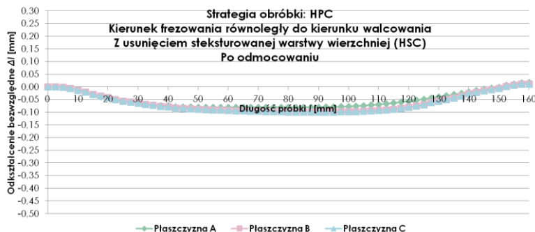
Rys. 5.36. Przebieg odkształcenia bezwzględnego \Delta l w funkcji długości próbki l , po odmocowaniu, dla strategii HPC, równoległego kierunku frezowania w stosunku do kierunku walcowania i wariantu z zastosowaniem obróbki wstępnej HSC
