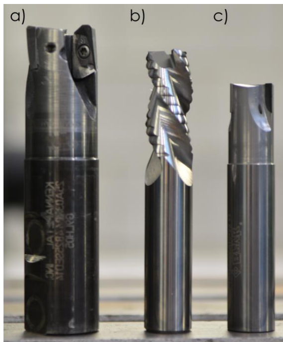
Rys. 4.6. Narzędzia stosowane w badaniach: a) frez składany Kennametal, b) frez węglkowy Sandvik, c) frez z ostrzami PKD Bryk
