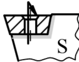
Rys. 2.6. Schematy różnych sposobów mocowania płytek a) mocowanie od góry – C, b) mocowanie na otworze – P, c) mocowanie od góry i na otworze – M, d) mocowanie śrubą na otworze – S [5]
