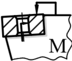
Rys. 2.6. Schematy różnych sposobów mocowania płytek a) mocowanie od góry – C, b) mocowanie na otworze – P, c) mocowanie od góry i na otworze – M, d) mocowanie śrubą na otworze – S [5]
