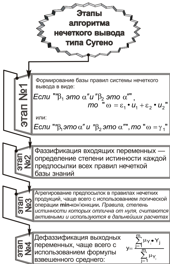
Рис. 9.1. Этапы выполнения алгоритма нечеткого вывода типа Сугено Источник: собственная разработка на основе [2, 15]
