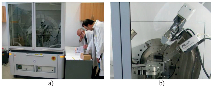
Rys. 3.5. Widok wysokorozdzielczego dyfraktometru rentgenowskiego Empyrean (a) i układu pomiarowego (b)
