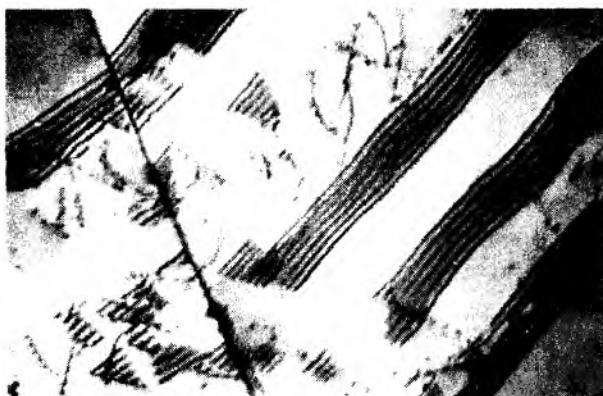
Rys.38. Mikrostruktura stopu M2 po przesycaniu 1373 K/2 h i starzeniu 1023K/100 h: a) mikr.św., b) SEM, c) TEM
