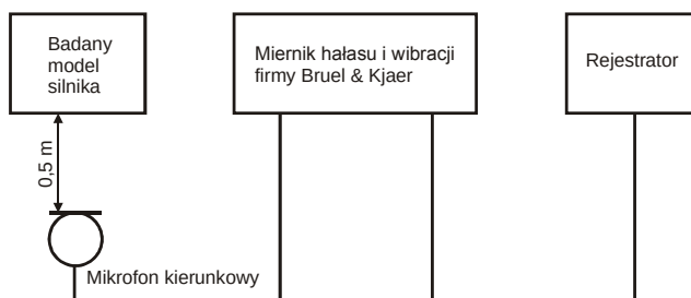
Rys. 6.19. Schemat pomiarowy do wyznaczania widma hałasu
