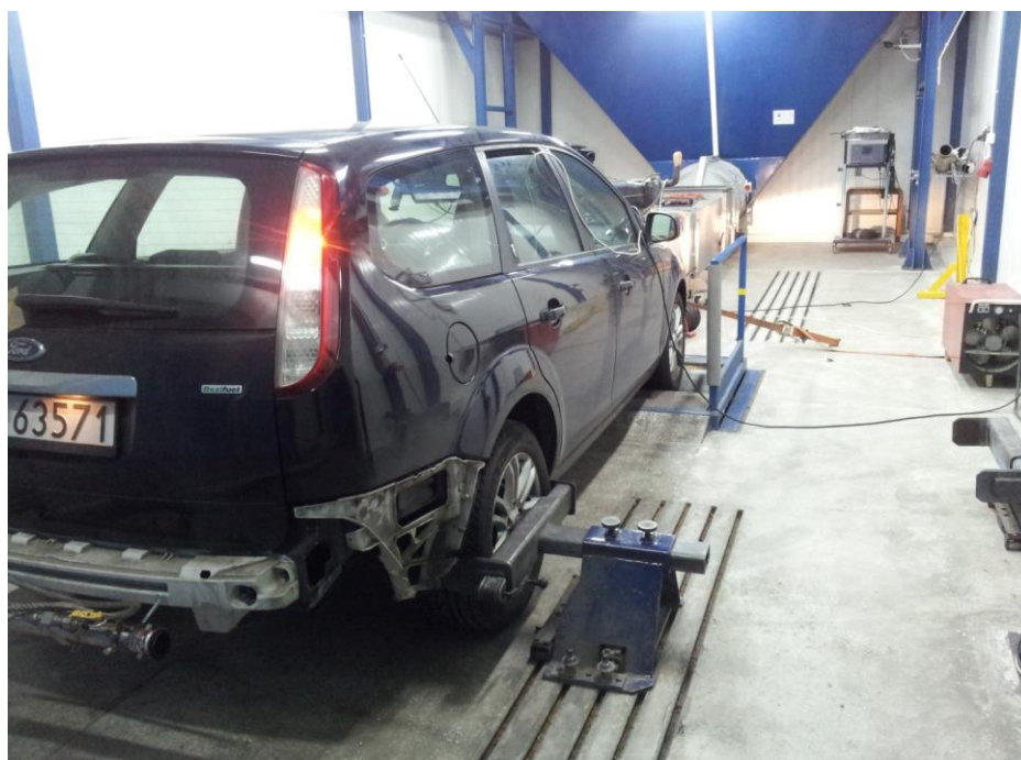
Rys. 8.1. Samochód Ford Focus Flexifuel na stanowisku badawczym
