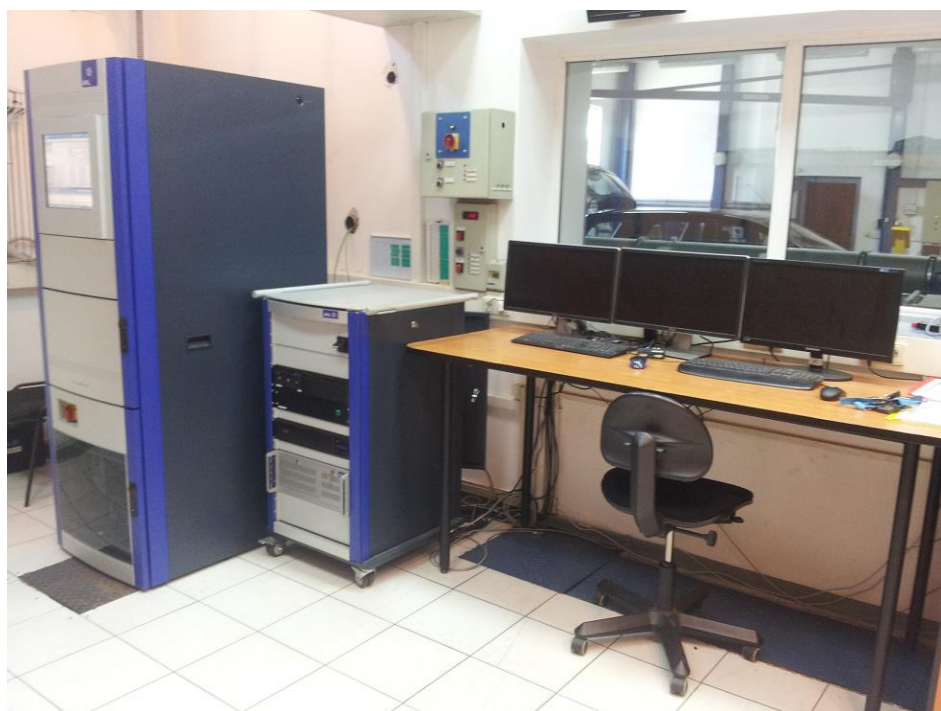
Rys. 8.2. Stanowisko pomiarowe hamowni podwoziowej
