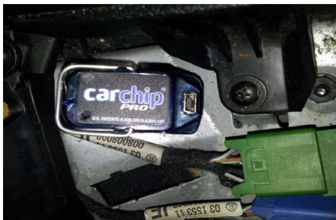
Rys. 7.6. Urządzenie rejestrujące CarChip Pro w gnieździe OBD pojazdu
