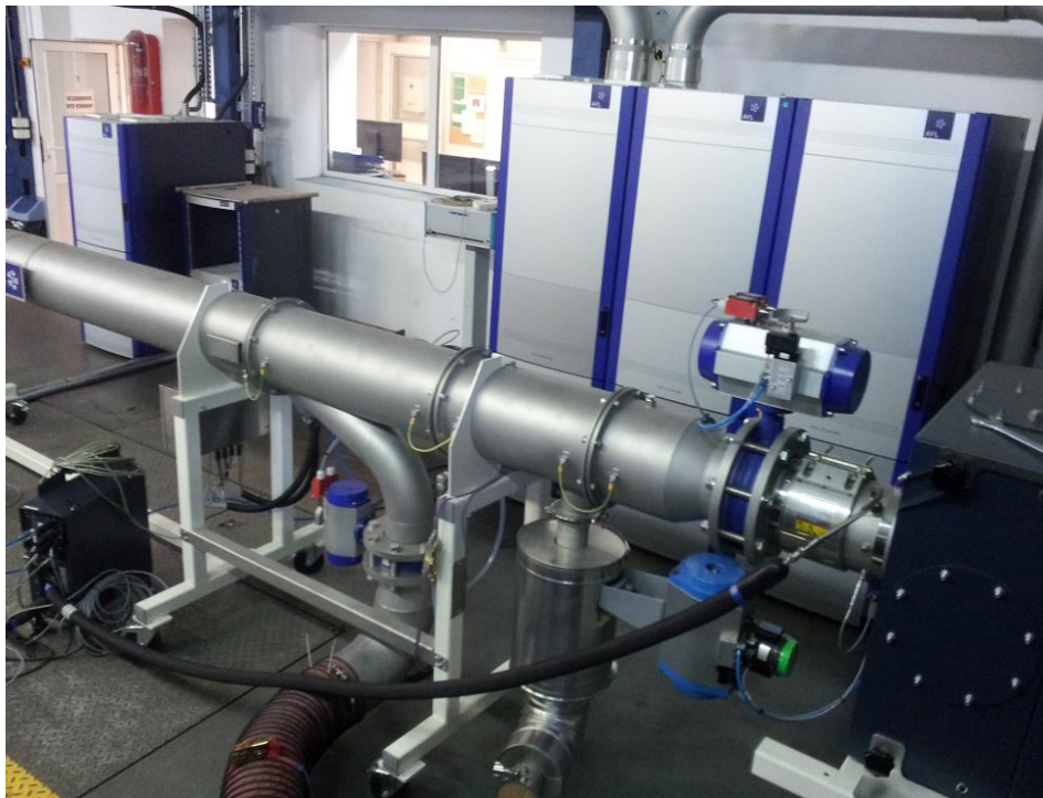
Rys. 8.3. Zestaw urządzeń pomiarowych AMA i60
