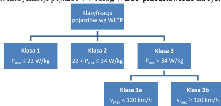
Rys. 3.7. Klasyfikacja pojazdów samochodowych wg WLTP [54]
