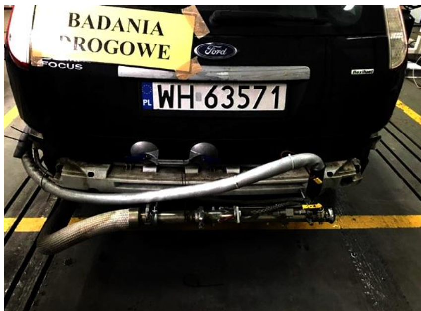
Rys. 7.5. Instalacja poboru spalin z układu wydechowego wraz z przepływomierzem urządzenia SEMTECH DS zainstalowana na pojeździe badawczym
