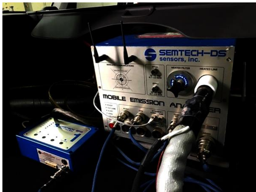
Rys. 7.4. Mobilny analizator SEMTECH DS zainstalowany w pojeździe badawczym Ford Focus Flexifuel
