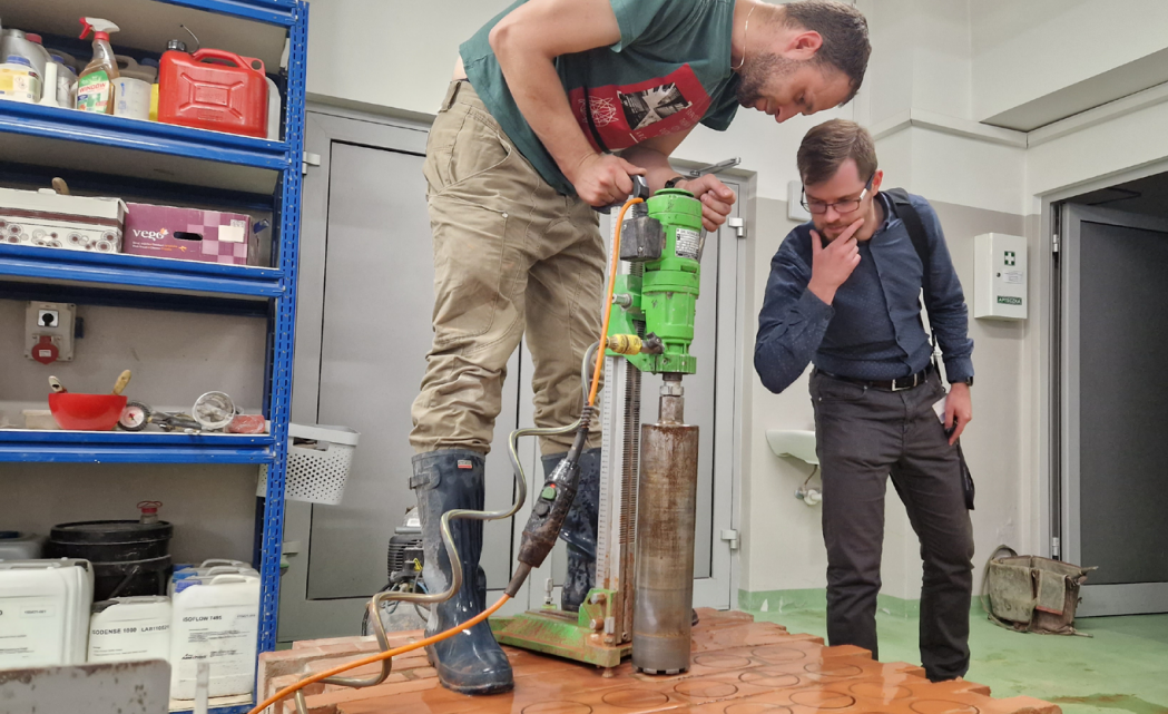
Pobieranie odwiertów rdzeniowych do badań wytrzymałościowych Źródło: archiwum LB
