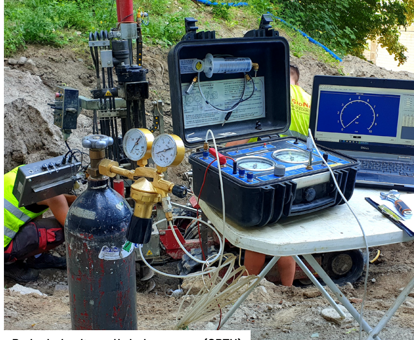
Badania in situ podłoża lessowego (CPTU)
