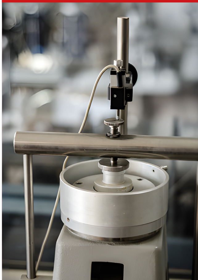
Badania laboratoryjne gruntów (ściskanie trójosiowe oraz edometryczne) Źródło: archiwum KIMBiG
