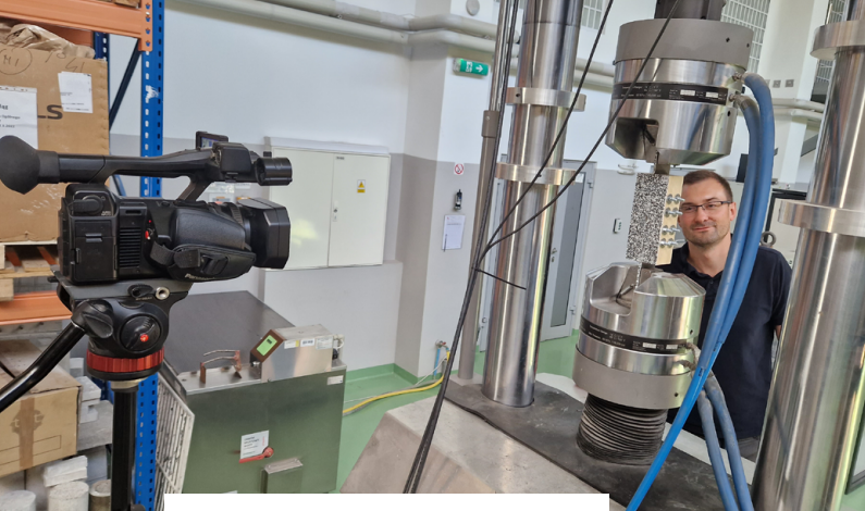
Badanie wytrzymałości połączeń hybrydowych (klejono-śrubowych) Źródło: archiwum LB
