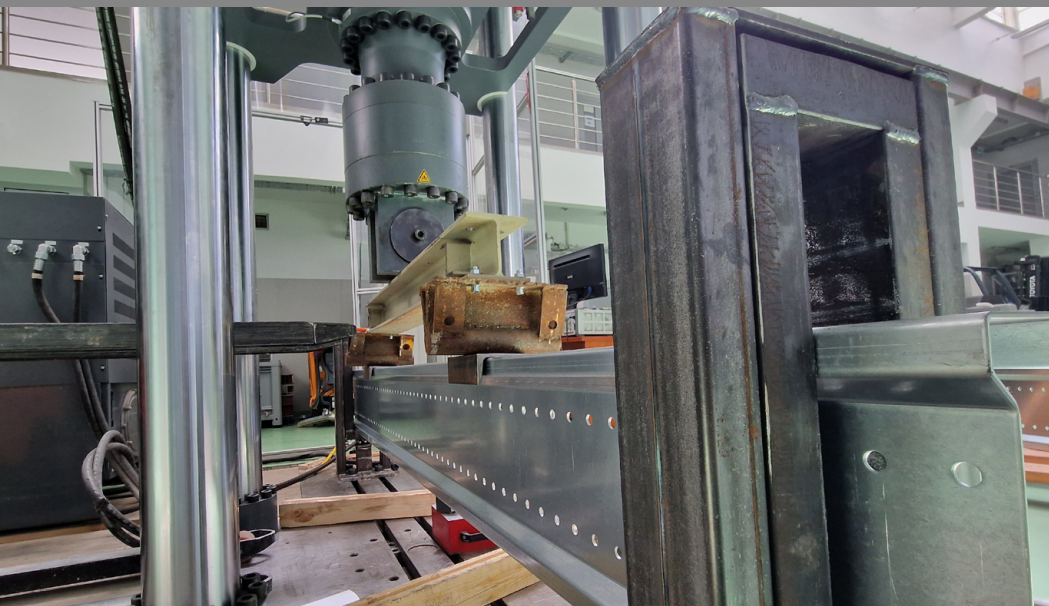
Badanie wytrzymałości na zginanie profili stalowych Źródło: archiwum LB
