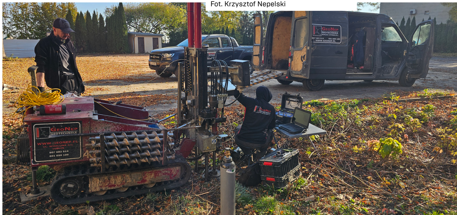
Badania in situ podłoża lessowego (CPTU)
