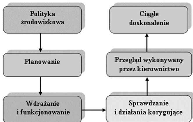
Rys. 23. Model zarządzania środowiskowego według ISO 14001 (opracowanie własne na podstawie [64])
