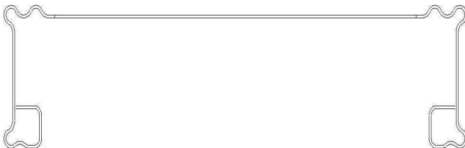
Rys. 2. Przekrój poprzeczny pomostu stalowego firmy ALTRAD MOSTOSTAL
