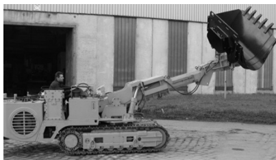
Rys. 2. Ładowarka bocznie wysypująca ŁBT-1200EH/LS-A [6]
