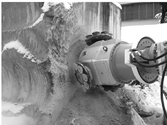
Rys. 12. Widok kombajnu KR 150 z nowym rozwiązaniem głowicy z narzędziami dyskowymi niesymetrycznymi o złożonej trajektorii ruchu podczas jednej z prób poligonowych
