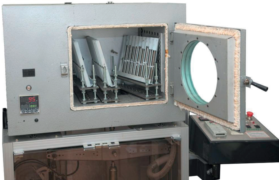
Rys. 34. Komora grzewcza wykorzystywana do utwardzania cieplnego próbek z trzema wypełnionymi przyrządami do przechowywania próbek przy utwardzaniu
