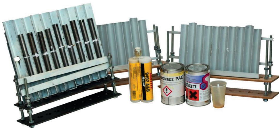
Rys. 33. Widok próbek na przyrządzie klejarskim
