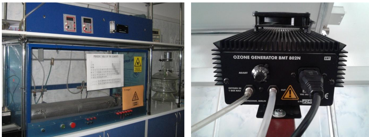
Rys. 3.6. Stanowisko do ozonowania materiałów konstrukcyjnych
