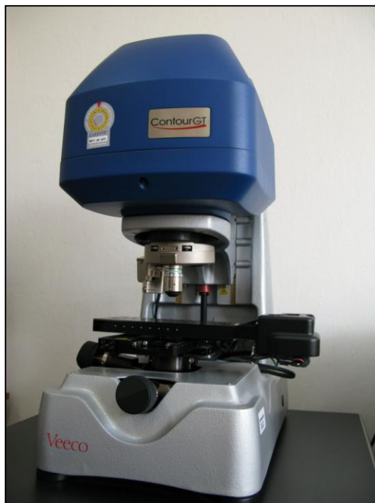
Rys. 3.9. Profilometr optyczny Contour GT-K1
