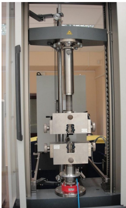
Rys. 3.11. Maszyna wytrzymałościowa Zwick/Roell Z150
