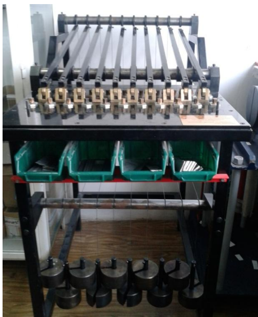
Rys. 3.4. Stanowisko laboratoryjne do wykonywania połączeń klejowych
