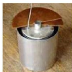
Rys. 1. Zestaw pomiarowy do wyznaczania ciepła topnienia lodu
