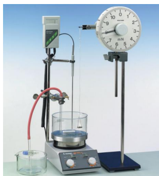
Rys. 6. Zestaw do pomiaru napięcia powierzchniowego
