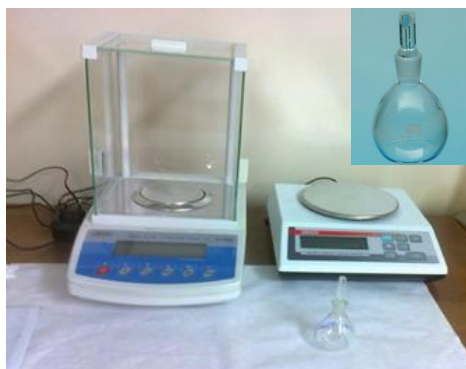
Rys. 7. Zestaw do pomiaru gęstości przy pomocy piknometru
