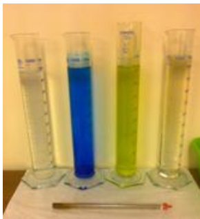
Rys. 10. Zestaw do pomiaru gęstości metodą ciała pływającego
