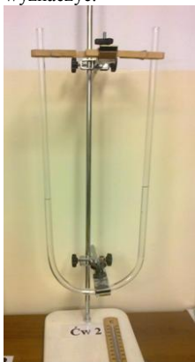
Rys. 9. Zestaw do pomiaru gęstości metodą naczyń połączonych
