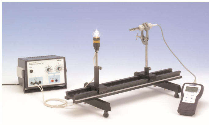
Rys. 3. Zestaw pomiarowy do badania prawa fotometrii.
