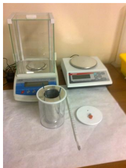
Rys. 1. Zestaw pomiarowy do wyznaczania ciepła topnienia lodu
