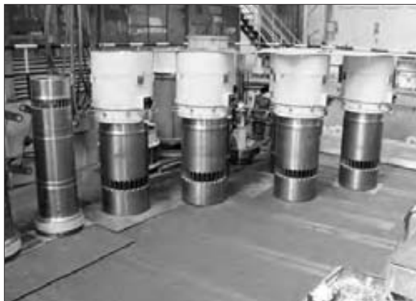
Tuleje cylindrowe silnika okrętowego
