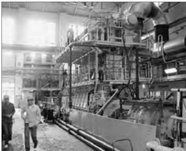
Silnik okrętowy 7RT-flex50 na hamowni – na pierwszym planie widoczny jest hamulec
