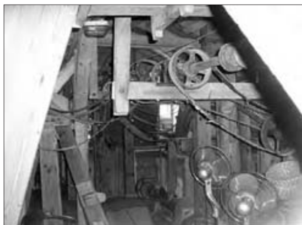
Wał główny systemu napędowego młyna
