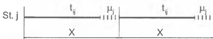
Rys. 7.1. Struktura okresu powtarzalności stanowiska roboczego w potoku stałym o niepełnym obciążeniu [15]
