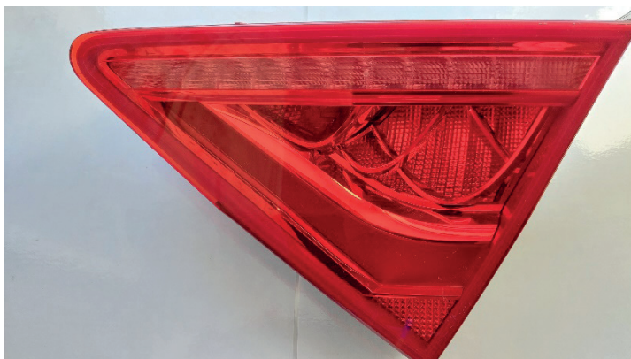
Rys. 9.4. Tylne lampy pojazdu z diodami LED
