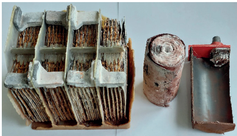
Rys. 2.1. Budowa wewnętrzna akumulatora standardowego i akumulatora typu AGM z elektrodami spiralnymi
