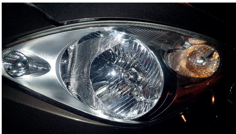
Rys. 9.2. Reflektor samochodowy z żarówkami halogenowymi
