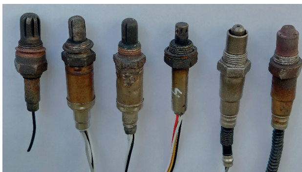
Rys. 8.7. Czujniki tlenu z zewnętrznymi uszkodzeniami
