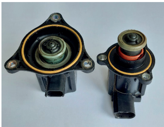
Rys. 7.9. Zawory elektromagnetyczne (budowa zewnętrzna)
