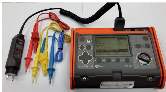
Rys. 1.1. Miernik parametrów instalacji elektrycznej z osprzętem pomiarowym
