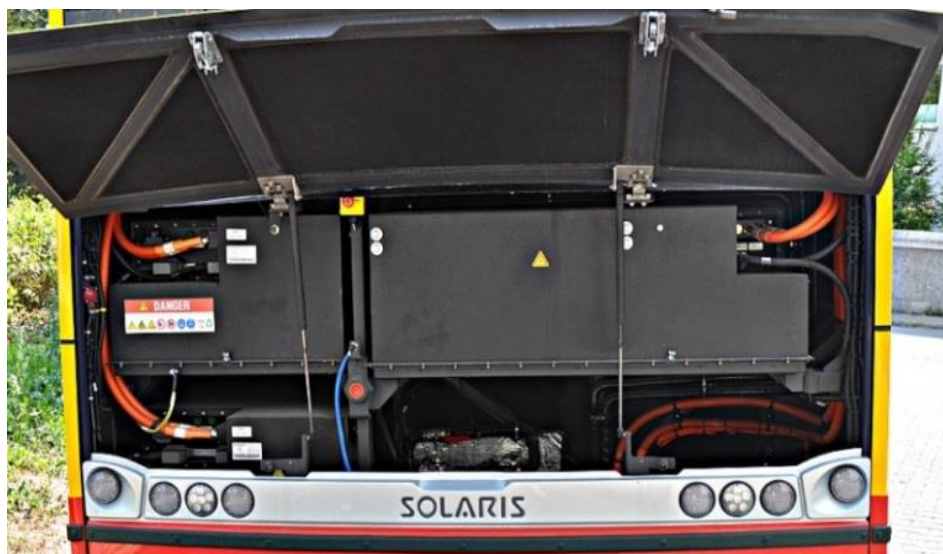
Rys. 1.5. Baterie litowo-jonowe zastosowane w autobusie typu Urbino 12 Electric
