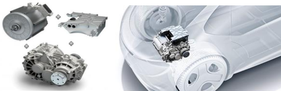
Rys. 1.4. Struktura i miejsce zamontowania E-osi [136]
