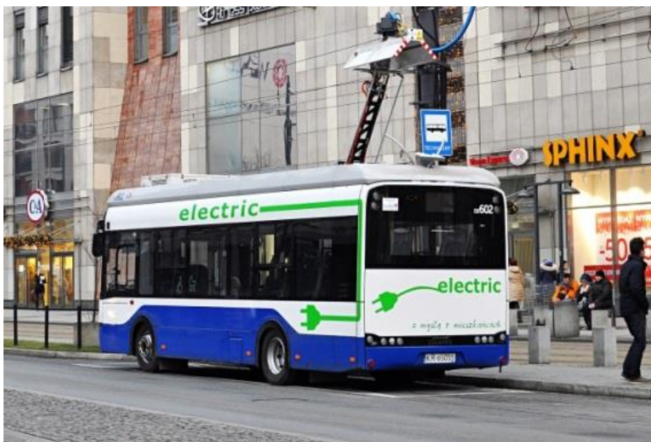
Rys. 1.6. Autobus miejski typu Urbino 8,9 LE Electric w trakcie ładowania baterii trakcyjnych przy użyciu pantografu
