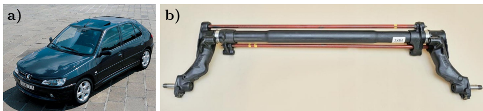
Rys. 2.5. Peugeot® 306 hatchback a) i belka skrętna b) z tego pojazdu, będąca przedmiotem analiz
