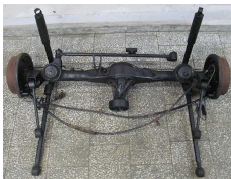
Rys. 1.5. Tylny most napędowy z układem zawieszenia samochodu Daihatsu® Terios
