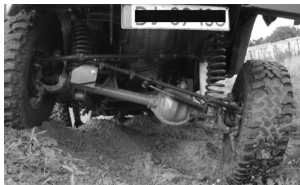
Rys. 1.3. Przykład zastosowania drążka Panharda w konstrukcji przedniego zawieszenia
