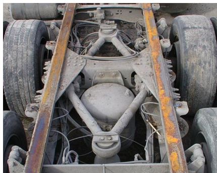
Rys. 1.1. Drażek reakcyjny w zawieszeniu samochodu Volvo FH
