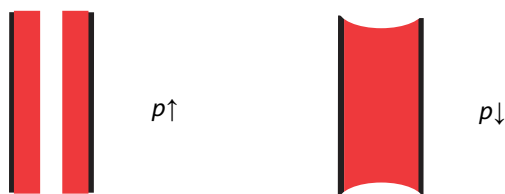
Rys. 18. Wypełnienie długich, cylindrycznych, obustronnie otwartych porów adsorbentem przy adsorpcji (wzrost p ) i desorpcji (spadek p ).
