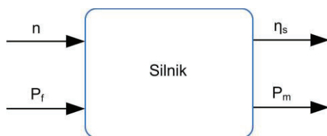
Rys. 5.2. Model przetwarzania energii w silniku spalinyowym
