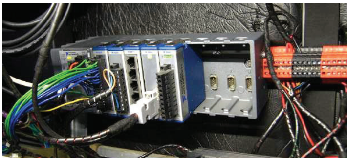
Rys. 11.2. Układy pomiarowe oparte na NI Compact RIO zamontowane w autobusie [66]
