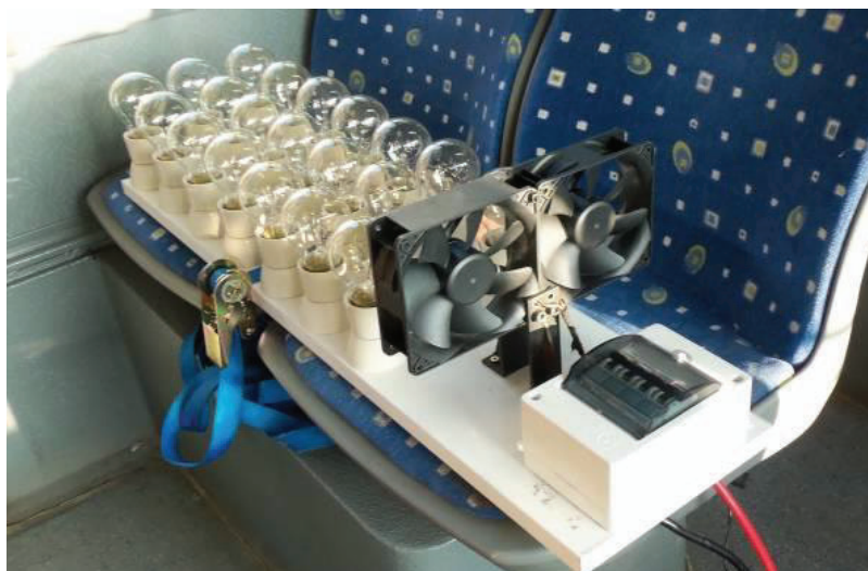
Rys. 11.5. Dodatkowe obciążenie alternatorów [66], fot. M. J. Gęca
