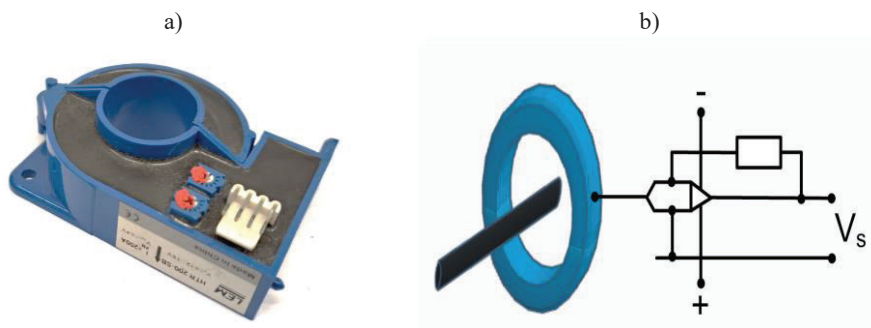
Rys. 11.3. Przetwornik prądowy serii HTR a) widok urządzenia, b) schemat działania opracowano na podstawie [149]
