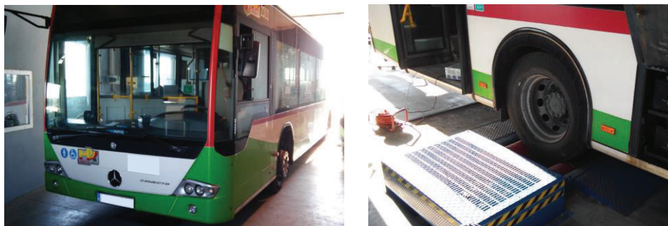
Rys. 7.1. Autobus Mercedes Conecto na hamowni podwoziowej
