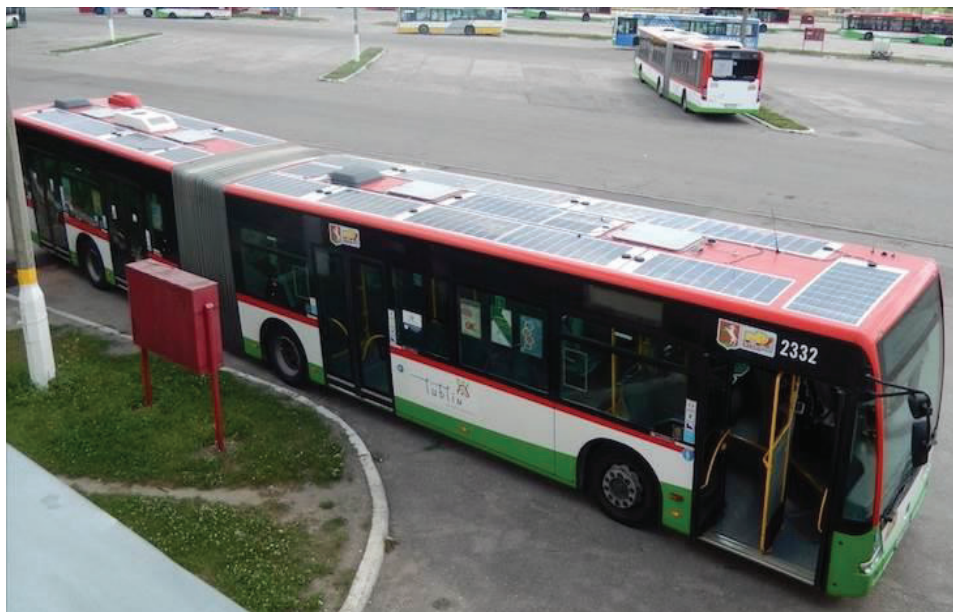
Rys. 2.15. Instalacja fotowoltaiczna zamontowana w autobusie miejskim [58]
