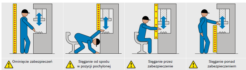
Rys. 14.9. Przykłady niewłaściwie zamontowanych ESPE [28]
