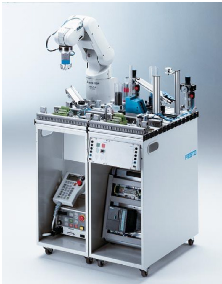
Rys. 10.10. Robot przemysłowy na stanowisku dydaktycznym [9]
