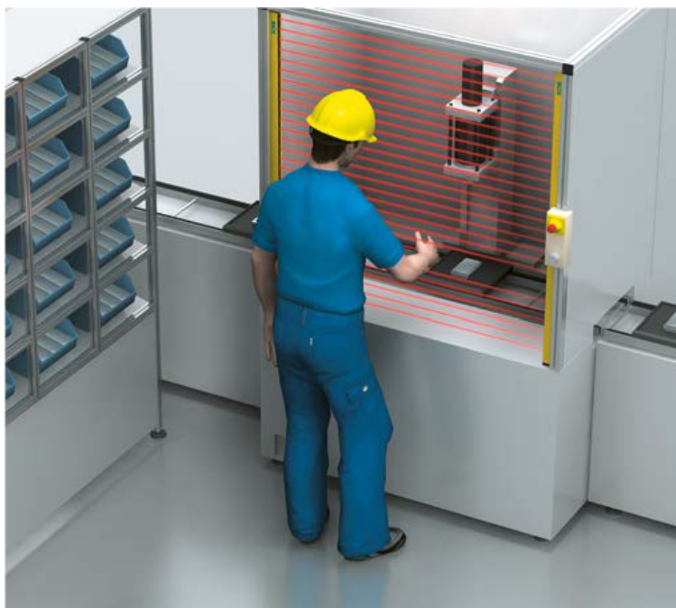
Rys. 14.4. Przykład zabezpieczenia strefy wymagającej okresowego działania operatora [28]
