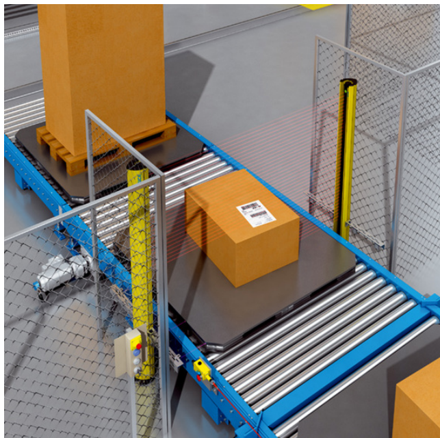
Rys. 14.6. Przykłady funkcji mutingu w procesie transportu [29]
