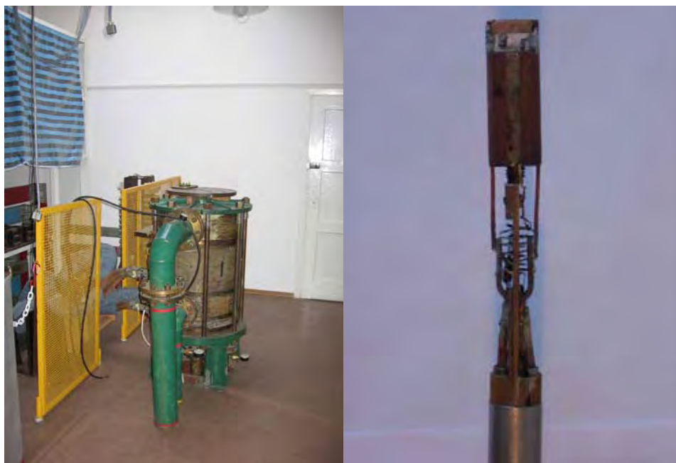
Rys. 5 . Zdjęcie z lewej strony przedstawia magnes biterowski 20 [ T ] używany podczas pomiarów prądu krytycznego. Z prawej strony zdjęcie przedstawia element wstawki do pomiarów prądu krytycznego w którym umieszczane są próbki podczas pomiarów.
