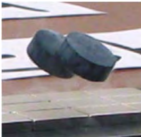
Rys. 4. Widok lewitujących nadprzewodników wysokotemperaturowych w polu magnetycznym magnesu trwałego
