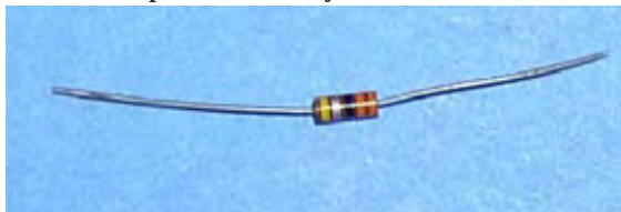
Rys 3. Rezystor pełniący rolę wskaźnika poziomu helu
