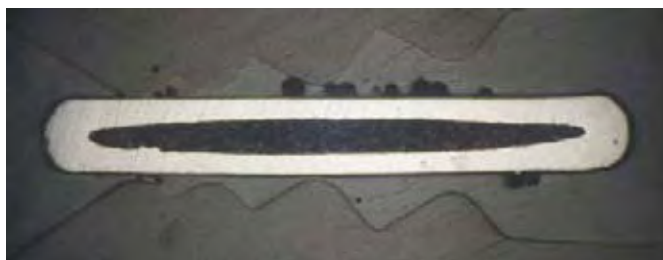
Rys. 4. Przekrój metalograficzny taśmy \text{MgB}_2 w stalowej matrycy
