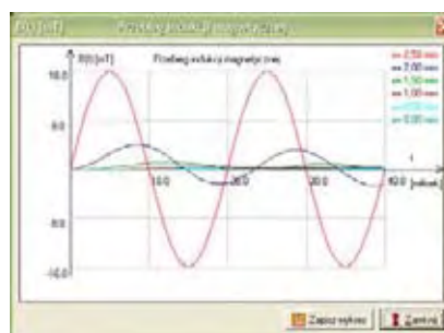
Wzrost magnetyzmu w pierśc. NCP - Model liniowy Charakterystyczne wielkości dyfuzji Współczynnik dyfuzyjności magnetycznej - D_m [m 2 /s] 1.59E-5 Głębokość wnikańia - \delta [mm] 0.3183 Stosunek grubości pierśc. do głęb. wnikańia - a/\delta 7.8540 Stosunek głęb. wnikańia do grubości pierśc. - \delta/a 0.1273 Rozwiązanie numeryczne równania dyfuzji Obliczenia w wartościach: bezwzględnych - B [mT], x [mm] względnych - B/B_{max} [-], x/a [-] Liczba podprzedziałów przedziału x/a - 0 \leq x/a \leq 10 Krok dyskretyzacji w kierunku osi x - \Delta x 0.50 mm Czas obserwacji rozwiązywania - t_{max} [mikros] 40 Krok dyskretyzacji w kierunku osi t - \Delta t 1 mikros 10 mikros 100 mikros 1 milisek. Rozwiąz równania dyfuzji Kontrola poprawności rozwiązania [OK lub BLAD]: OK Tablica wyników Wykres B(t) Amplituda B(t) Kąt fazowy B(t) Wstecz Koniec
