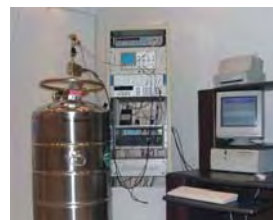
Rys. 9. System NISTVolt do odtwarzania jednostki napięcia elektrycznego
