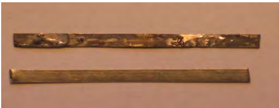
Rys. 12. Zdjęcie taśmy nadprzewodnikowej- u góry kawałek taśmy używany podczas pomiarów w których badany był wpływ wygięcia na I_c , na dole kawałek taśmy używany podczas pomiarów bez wygięcia
