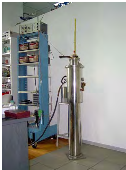
Rys 6 Kriostat w którym przeprowadzane były pomiary pola magnetycznego cewek
