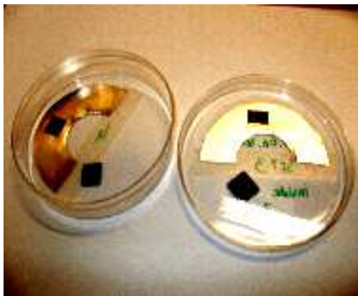
Rys. 3. Cząstki atmosferyczne zebrane za pomocą impaktora Bernera na podłożu z folii aluminiowej oraz z czystego krzemu (poziom 3 i 4 impaktpra) [opracowanie własne]
