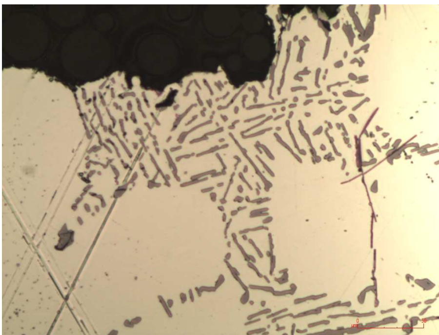
Rys. 4. Gruboziarnista eutektyka aluminium-krzem występująca w pobliżu przełomu (powiększenie x50) [opracowanie własne]
