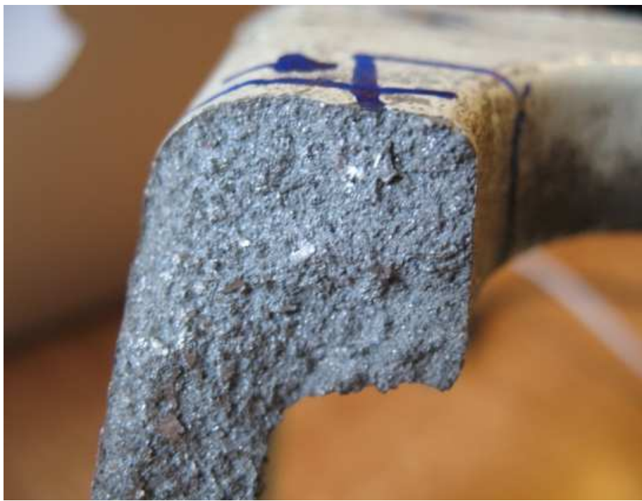
Rys. 1. Fragmenty przełamów z ramienia uszkodzonego robota: a) przełom z charakterystycznym uskokiem, b) część przełomu w poprzek ramienia z widocznym uszkodzeniem powstałym w trakcie demontażu, c) fragment przełomu międzykrystalicznego o charakterze doraźnym [opracowanie własne]
