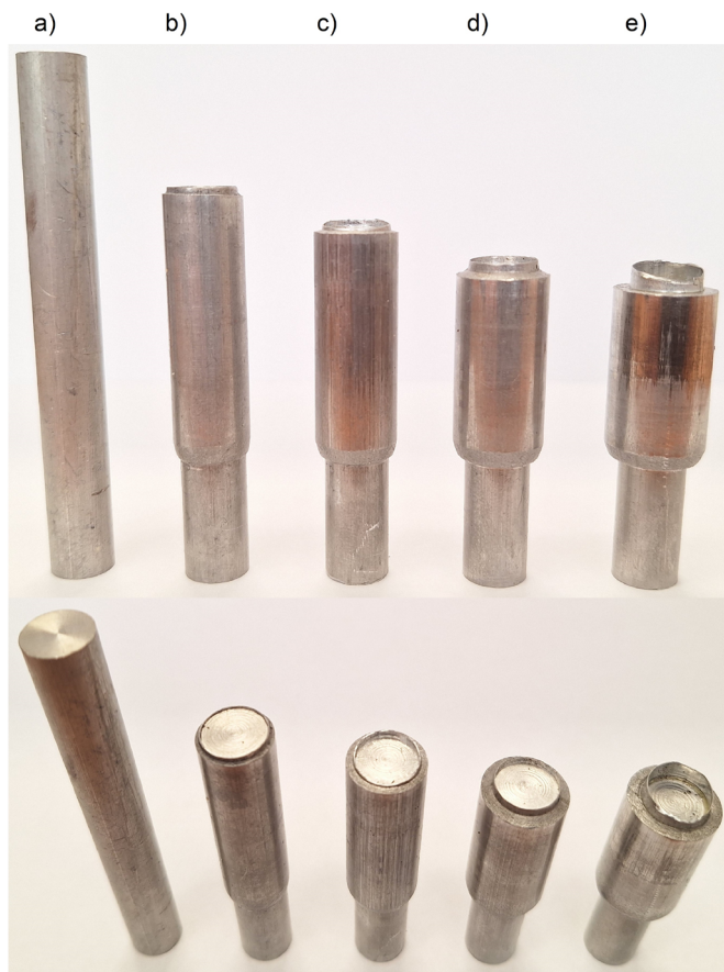
Ryc. 6.12. Odkuwki wykonane w badaniach doświadczalnych procesu spęczania ze strefą odkształcenia o zmiennym położeniu z zastosowaniem wsadu w postaci pręta (a), kształtowane z wykorzystaniem matrycy o kącie pochylenia strefy stożkowej \alpha = 40^\circ , redukcji przekroju poprzecznego wsadu równej \delta_p = 15\% oraz średnicy otworu kalibrującego: b) d_k = 12 mm, c) d_k = 13 mm, d) d_k = 14 mm, e) d_k = 15 mm
