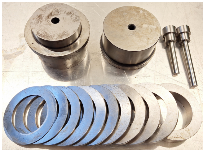
Ryc. 4.13. Narzędzia wykorzystane do analizy zjawiska wyboczenia pręta
