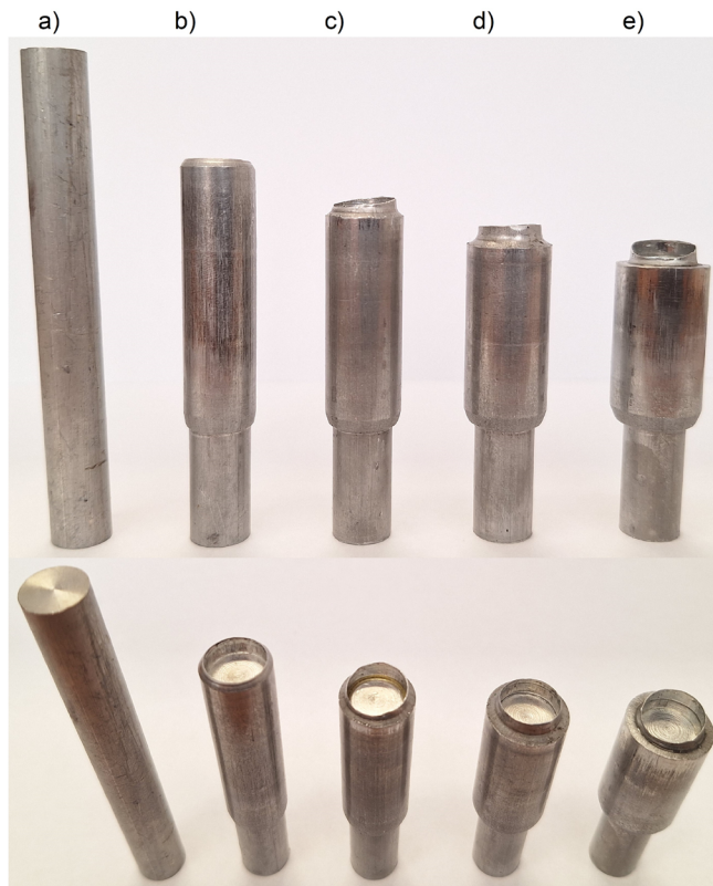
Ryc. 6.13. Odkuwki wykonane w badaniach doświadczalnych procesu spęczania ze strefą odkształcenia o zmiennym położeniu z zastosowaniem wsadu w postaci pręta (a), kształtowane z wykorzystaniem matrycy o kącie pochylenia strefy stożkowej \alpha = 40^\circ , redukcji przekroju poprzecznego wsadu równej \delta_p = 25\% oraz średnicy otworu kalibrującego: b) d_k = 12 mm, c) d_k = 13 mm, d) d_k = 14 mm, e) d_k = 15 mm
