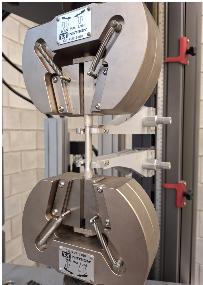
Ryc. 4.1. Widok próbki do statycznej próby rozciągania umieszczonej w przestrzeni roboczej maszyny wytrzymałościowej
