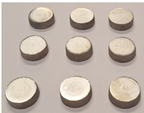
Ryc. 4.5. Próbki uzyskane podczas próby ściskania z prędkością kształtowania 4, 40 i 400 mm/min odpowiednio dla próbek przedstawionych w wierszu górnym, środkowym i dolnym
