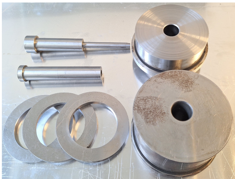
Ryc. 4.17. Narzędzia wykorzystane do analizy zjawiska wyboczenia ścianki wsadu rurowego
