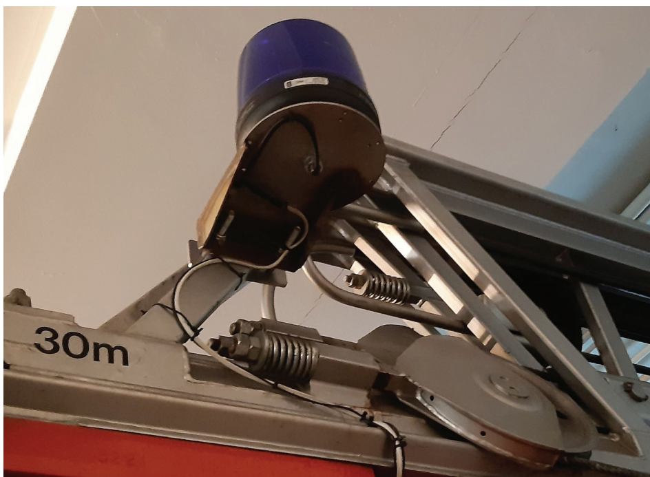
Rysunek 31. Lampa sygnalizacyjna zamocowana na przęśle drabiny [37]
