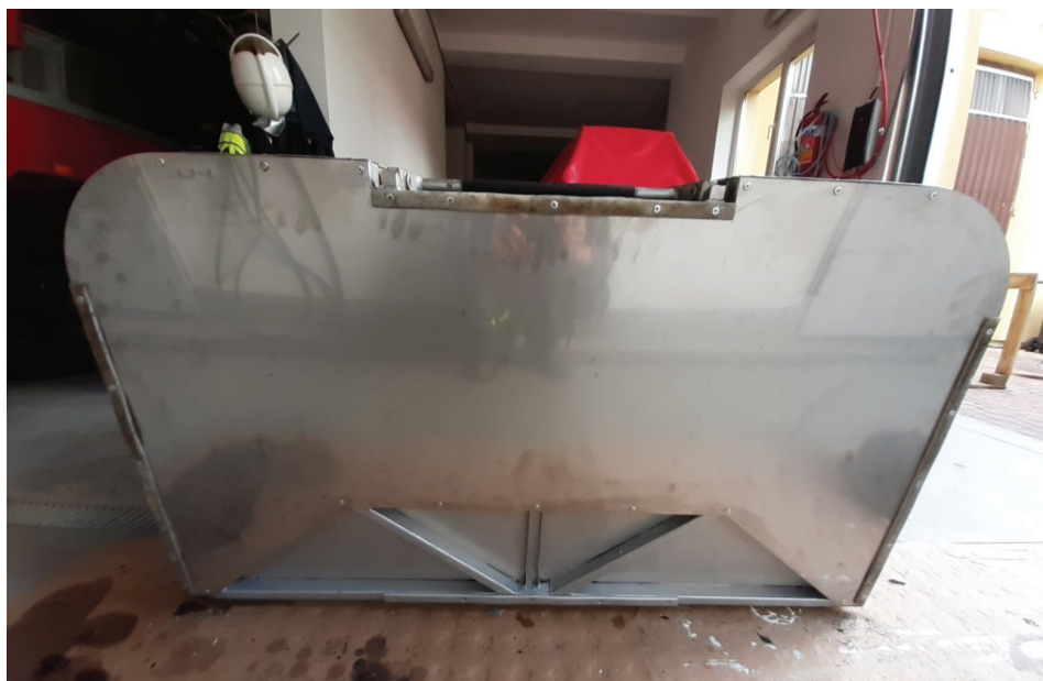
Rysunek 26. Mocowanie płyty do kosza [37]
