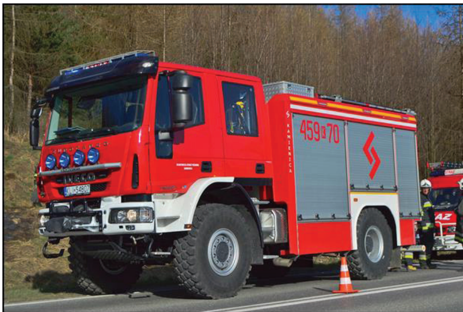
Rysunek 11. Pojazd kategorii 2-uterenowionej ze zwiększoną możliwością poruszania się w terenie [93].
