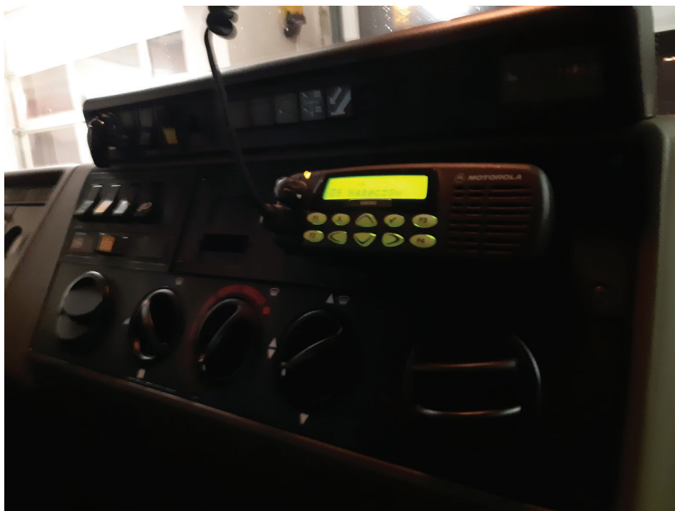
Rysunek 33. Zamocowany radiotelefon Motorola GM 360 [37]
