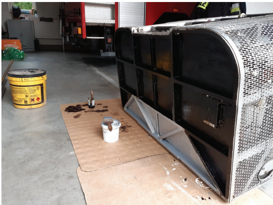
Rysunek 25. Zabezpieczenie antykorozyjne kosza [37]
