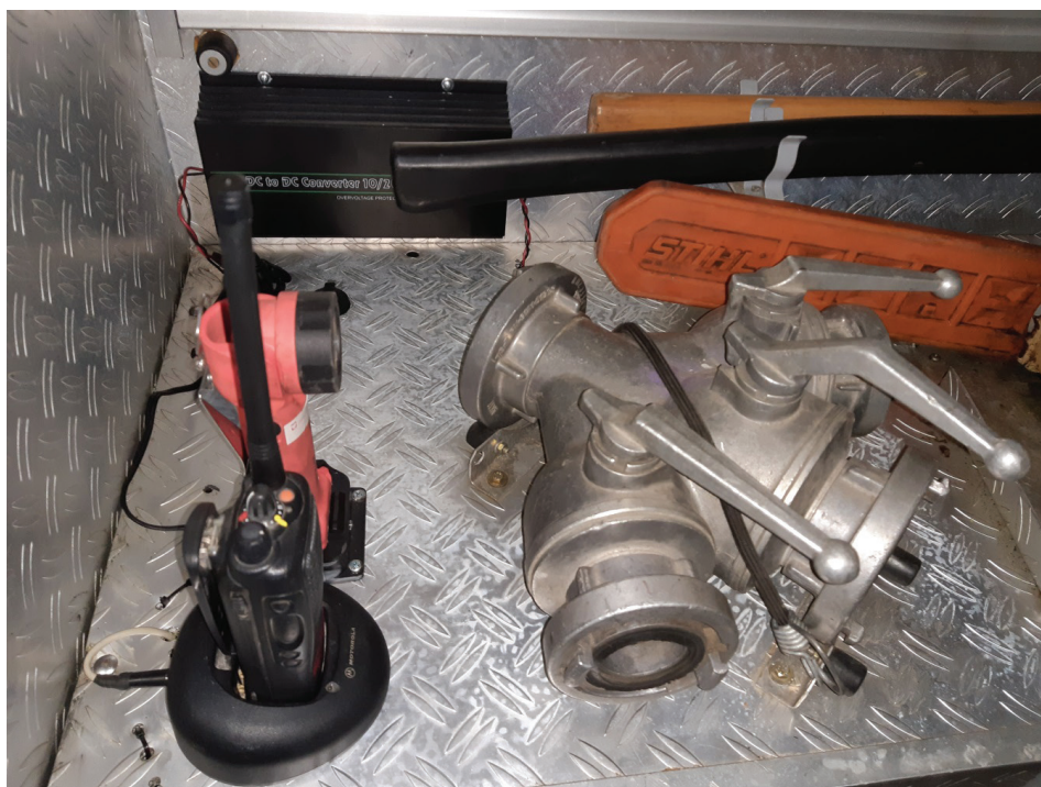
Rysunek 34. Przetwornica prądu oraz ładowarki w zabudowie pojazdu [37]
