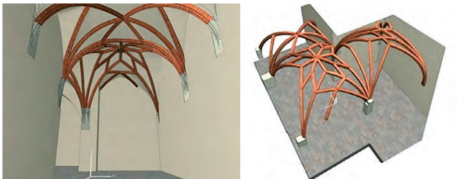
Il. 1. Model szkieletu żebier sklepienia gotyckiego gwiaździstego z inwentaryzowanym sprzętem flexijet w Krakowie w klasztorze oo. franciszkanów (2013 r.).
