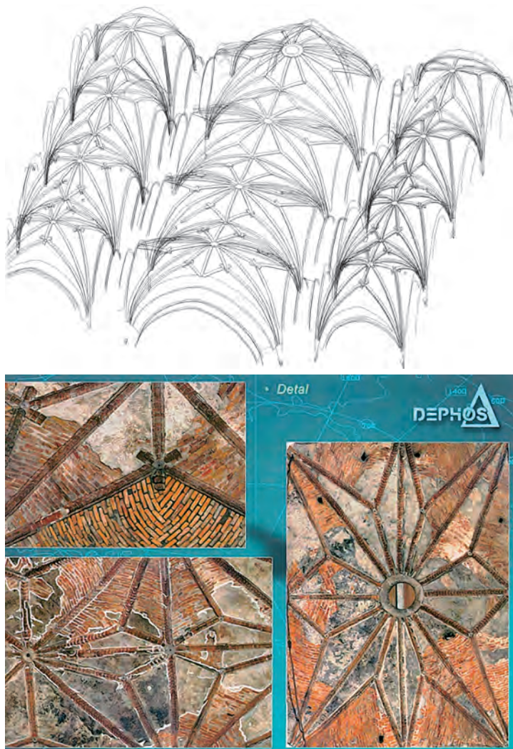
II. 4 Gdańsk, kościół św. Jana, model cyfrowy szkieletu żeber oraz ortofotoplan jednego przęsła.
