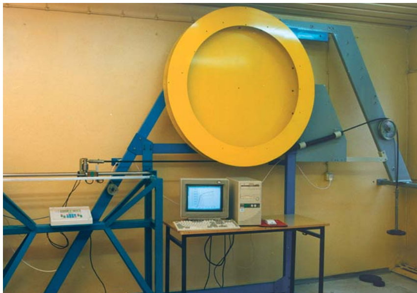
Stanowisko do badania współdziałania rur osłonowych i kabli optotelekomunikacyjnych
