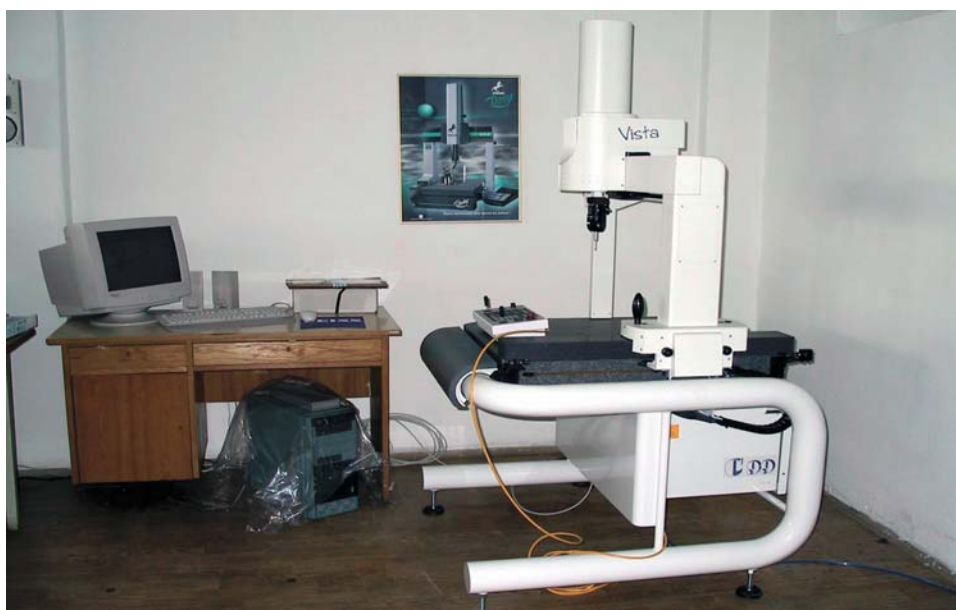
Współrzędnościowa maszyna pomiarowa ZEISS VISTA
