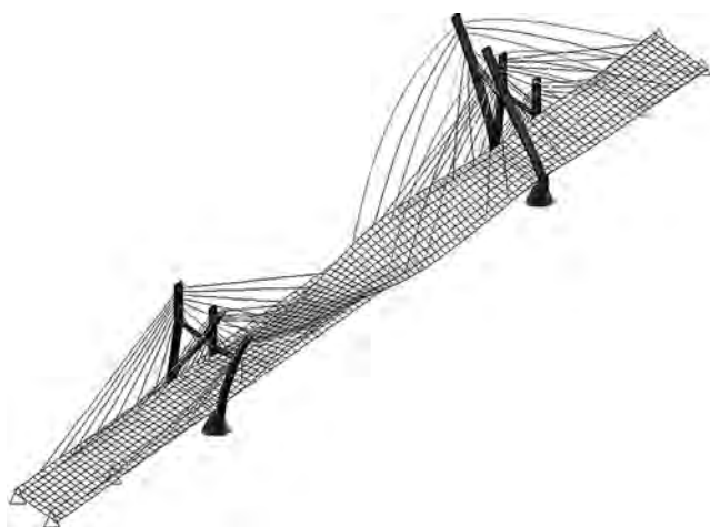
Symulacja drgań mostu Siekierskiego w Warszawie
