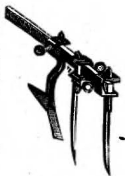
Ryc. 160. Szczegół budowy skaryfikatora łąkowego.
