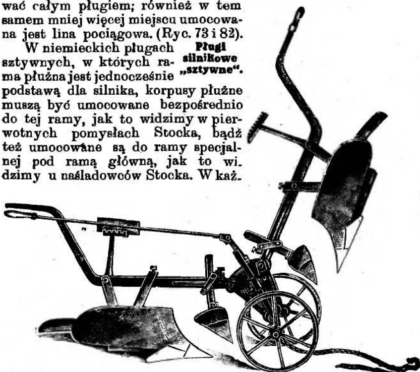
Ryc. 82. Pług obracalny do pociągu mechanicznego lub konnego.
