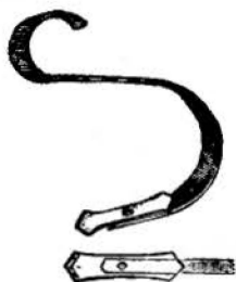
Ryc. 110. Zwykła redlica w sprężynówkach.
