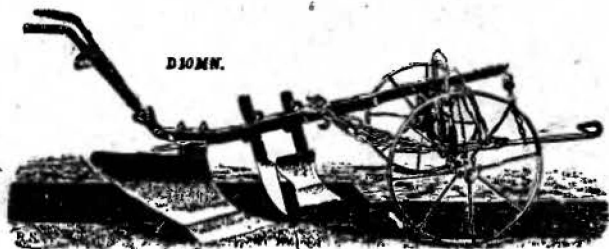
Ryc. 87. Pług piętrowy (z przedpłużkiem) typu Sacka.
