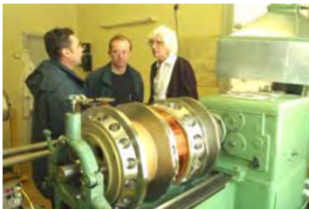
Rys.5. Elektromagnesu DECRIS-SC1 w trakcie nawijania
