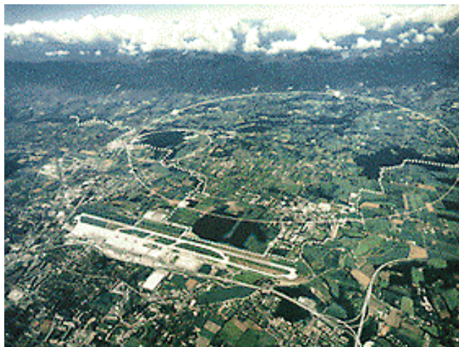
Rys. 2 Największy akcelerator w CERN-ie, LEP, obwód 27 kilometrów
