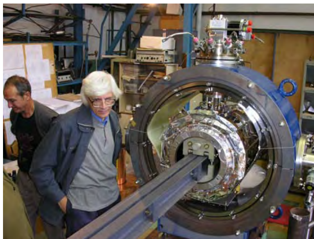
Rys.6. Elektromagnesu DECRISSC1 w trakcie montażu
