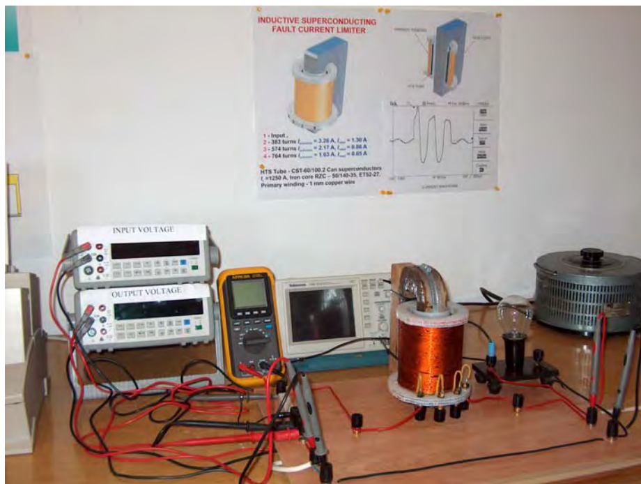
Rys. 3.4. Zdjęcie stanowiska pomiarowego ogranicznika SFCL 1250 A
