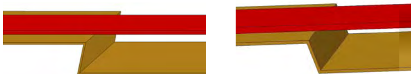
Rys. 4. Zmiana kształtu bocznika przed (po lewej) i po schłodzeniu (po prawej)
