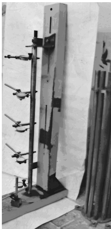
Rys. 6.17. Widok ogólny urządzenia do pomiaru odkształceń wału
