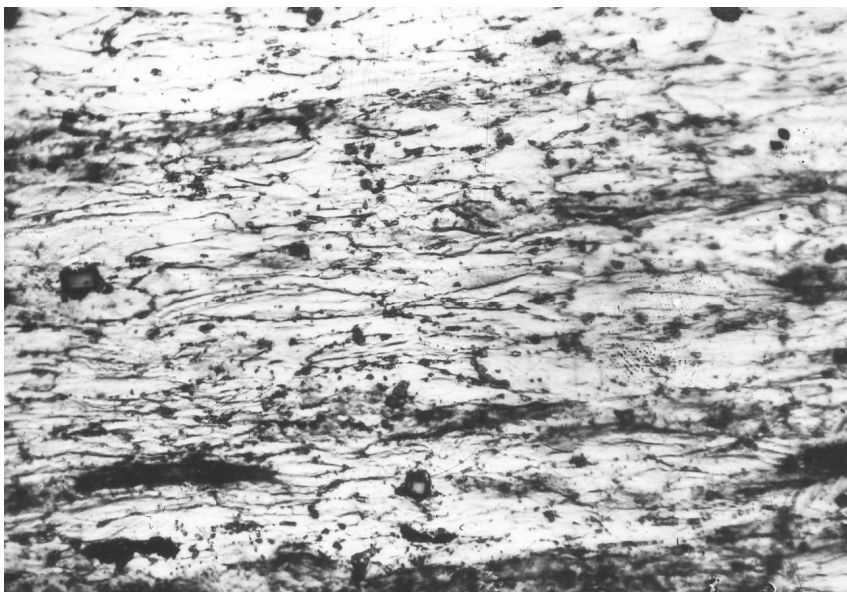
Rys. 5.3. Struktura próbki rozrywanej ( T^{\circ} = 200^{\circ}\text{C} ) przy 500-krotnym powiększeniu
