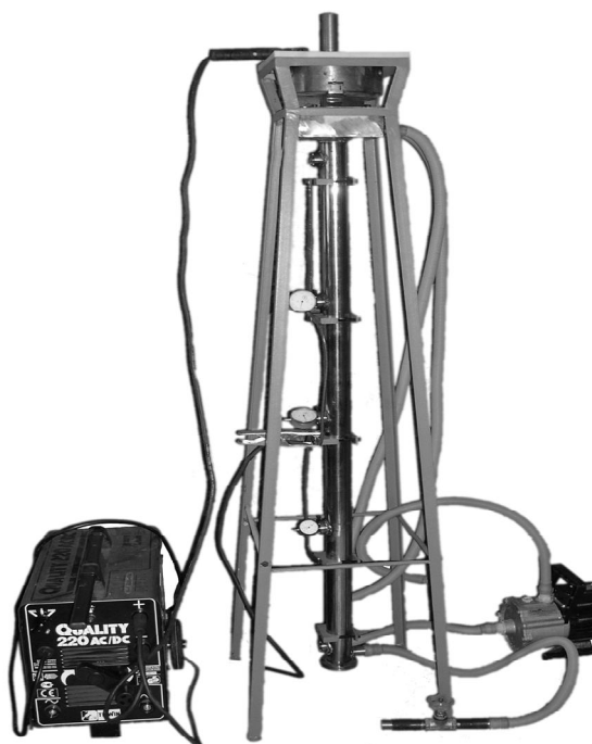
Rys. 6.15. Widok ogólny urządzenia do obróbki elektrochemicznej bez zbiornika na elektrolit
